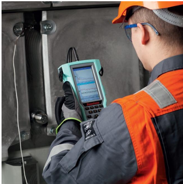
Kuva 3. Wärtsilän tärinäanalysointilaitteet propulsiojärjestelmille sekä muille pyöriville laitteille. (Wärtsilä.)
