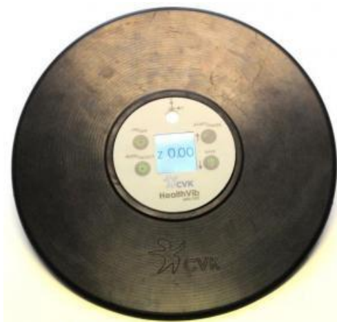
Kuva 6. HealthVib WBW300 – kokokehon värähtelymittauslaite. (MIP.)
