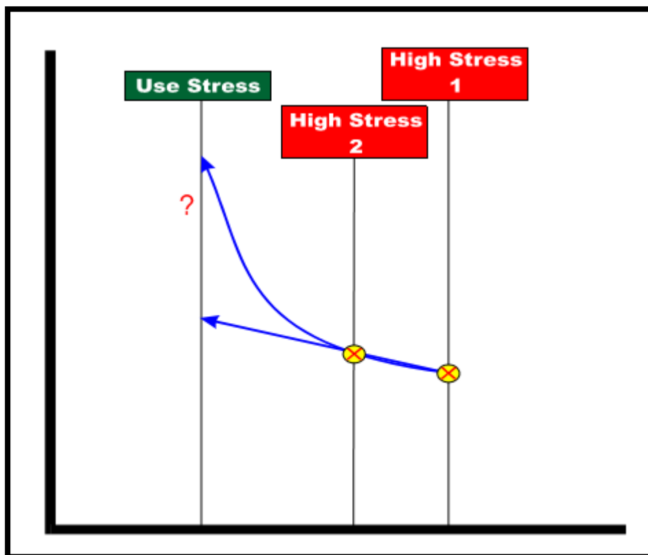
KUVA 2. Tulokset on helpompi sovittaa normaaliolosuhteisiin rasittamalla tuotetta useilla eri rasitus-tasoilla (Vassiliou & Mettas, 2003, 4.)
