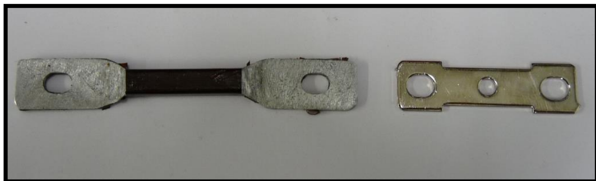
KUVA 25. Sähköisen liitoksen muodostava metallipari (Kaunismäki, 2017.)
