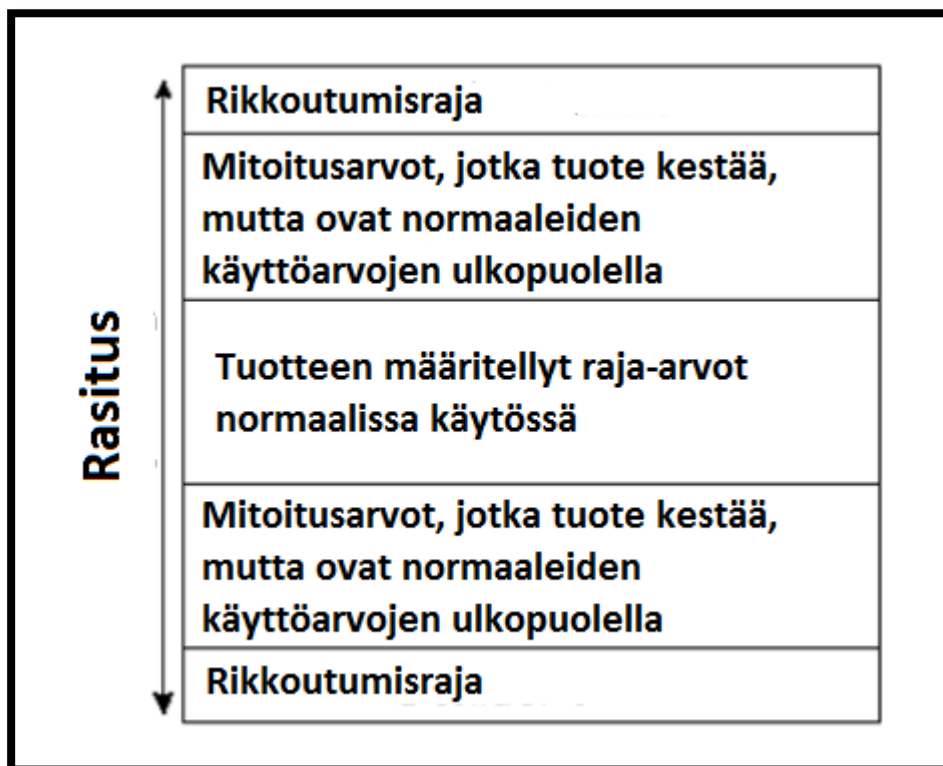
KUVA 3. Rasituksen tasot normaalikäytön rajoista rikkoutumiseen. Luotettavuustestauksessa käytetään usein rasituksia, jotka ovat normaalikäytön raja-arvojen ulkopuolella (mukailien Weibull.com, 2002.)
