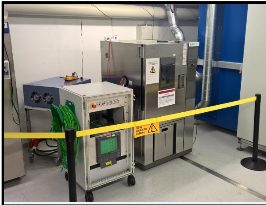
KUVA 27. Mittausjärjestely. Oikealla Espec-olosuhdekaappi, jonka vasemmalla puolella Yokogawan dataloggeri. Teholähde dataloggerin takana (Kaunismäki, 2017.)
