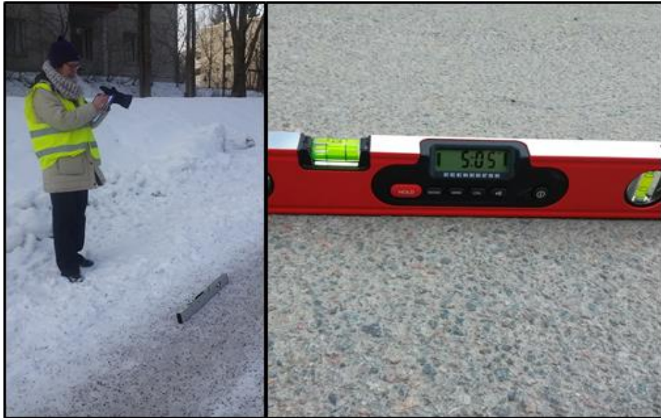
Kuva 11. Kaltevuusmittauksia Kaskitiellä kevättalvella 2016 sekä keväällä 2017.
