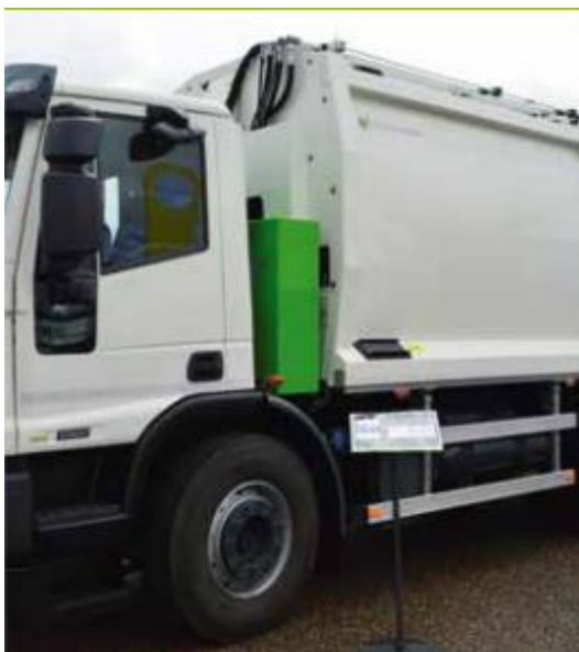
Kuva 3. Vihreä laatikko jätepakkaajan ja ohjaamon välissä on sähköyksikkö, jolla jätepakkaaja saadaan sähkökäyttöiseksi [18]
