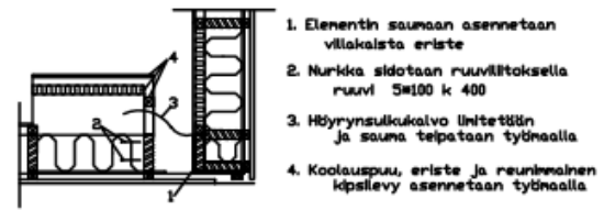
ELEMENTIN NURKKALIITOS DETALJI
