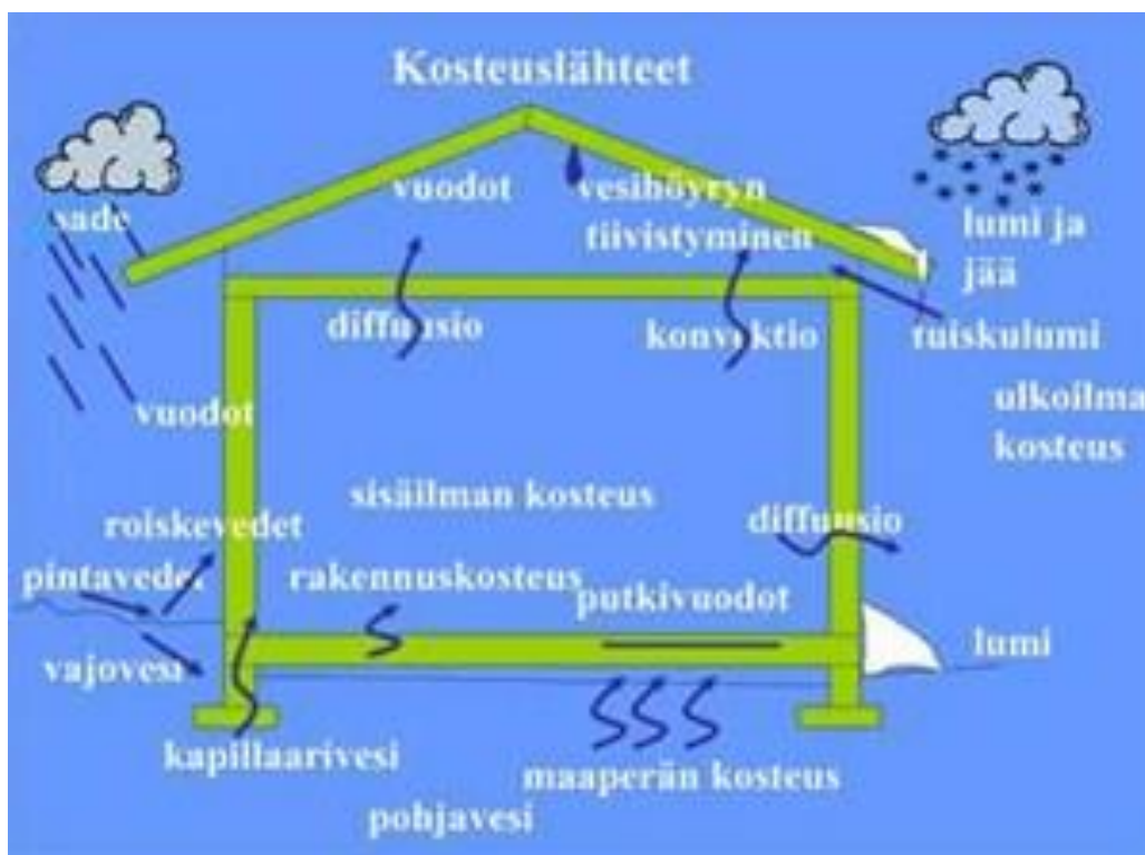
Kuva 2. Betonin kosteuslähteet (5, linkit Toteutus -> Kosteudenhallinta)
