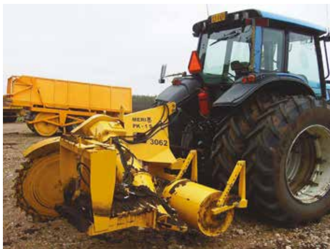
FIGURE 26. Suokone Oy's sod peat production machine Meri PK-1S (Turveruukki Oy).
