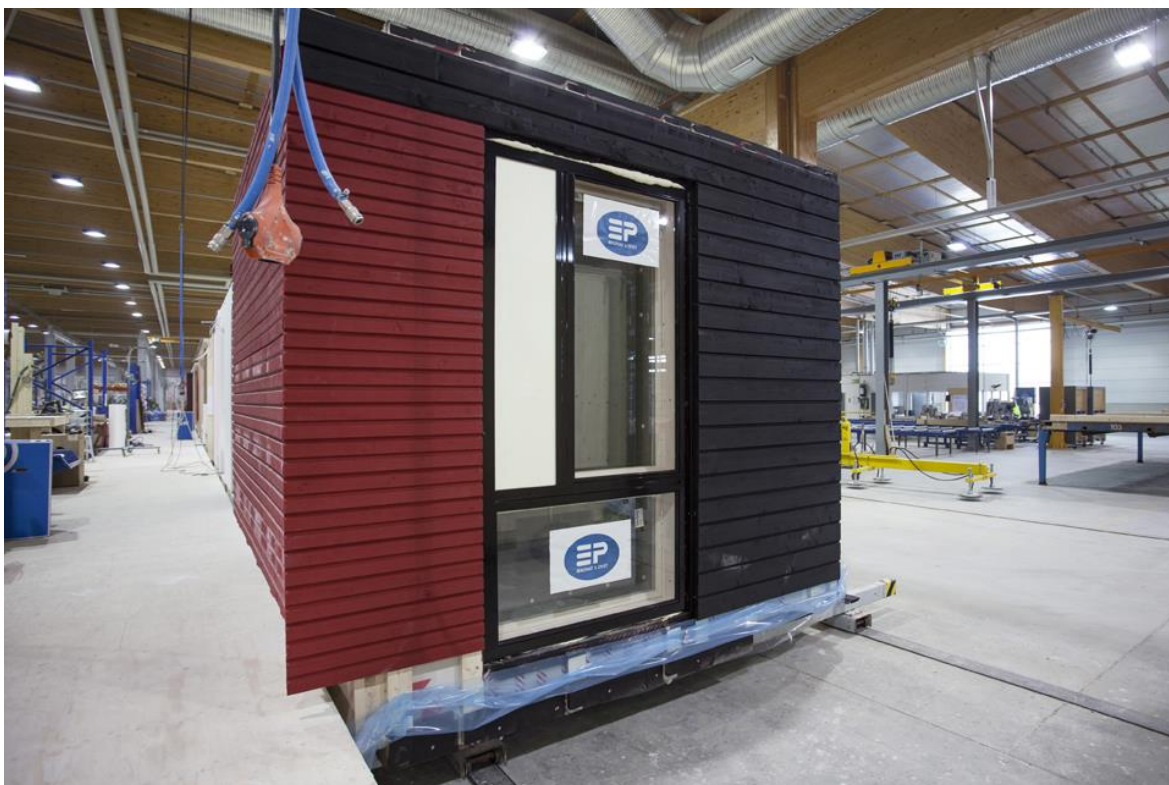
Kuva 5. Mäihän tilaelementit tehdään kuivissa olosuhteissa aina ulkoverhoukseen asti (Mattelmäki 2016).
