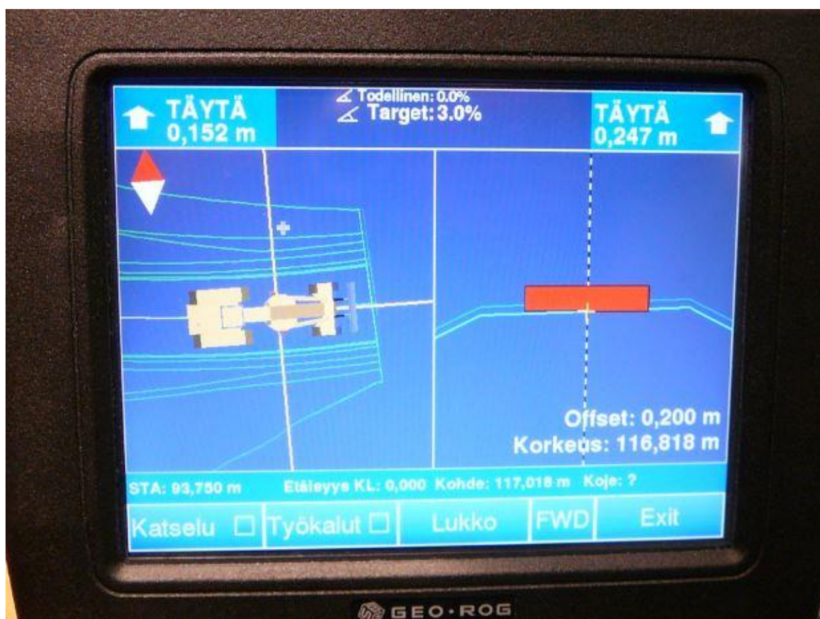
Kuva 17. Näkymä tiehöylään asennetun koneohjausjärjestelmän näytöltä (Hannuksela 2008)
