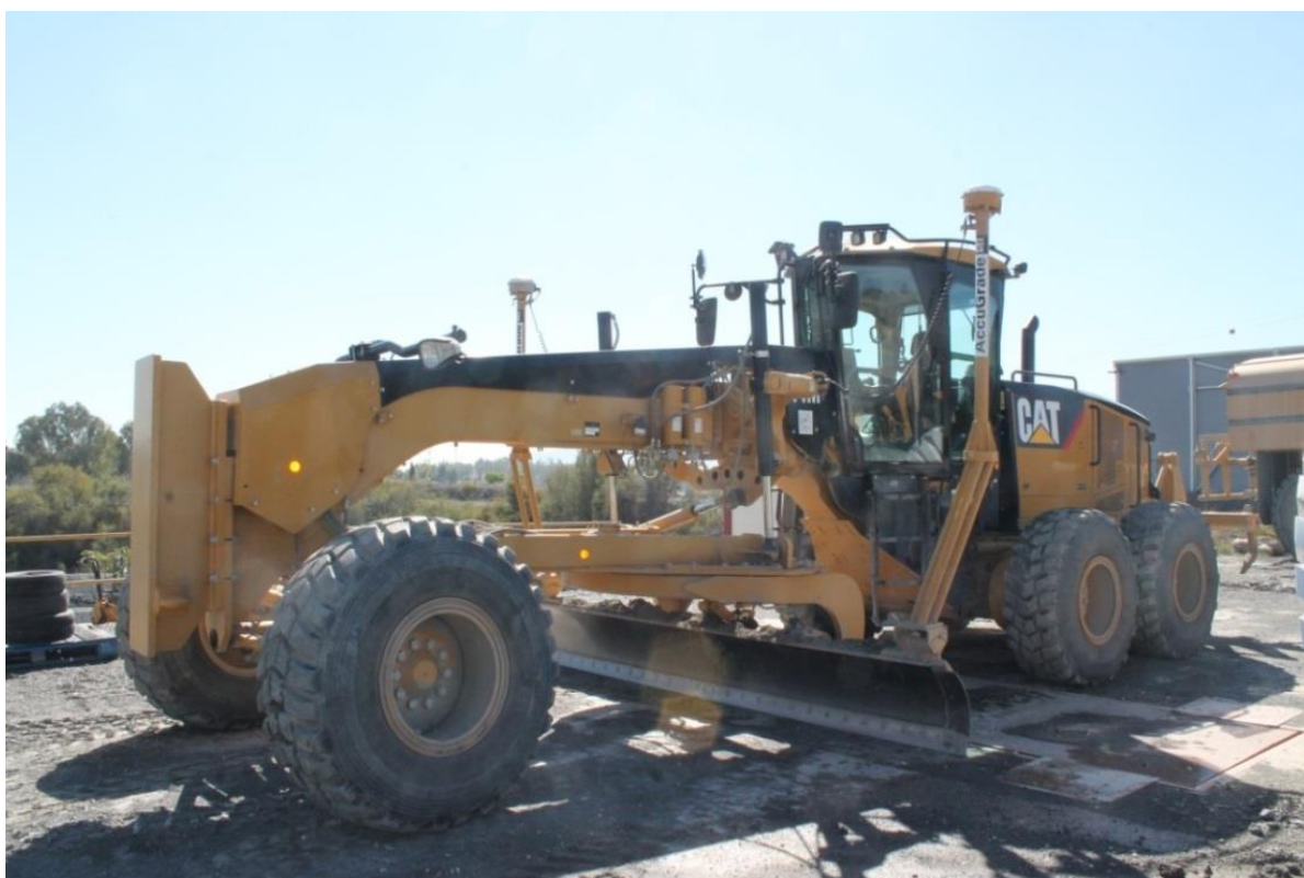
Kuva 15. Caterpillarin kehityskeskuksessa Malagassa esitteillä ollut GNSS-ohjattu tiehöylä. GNSS-vastaanottimet on asennettu pääterän molempiin päihin, jolloin koneeseen ei tarvita erillisiä työlaitteen asentoa seuraavia antureita. (Hannuksela 2015)
