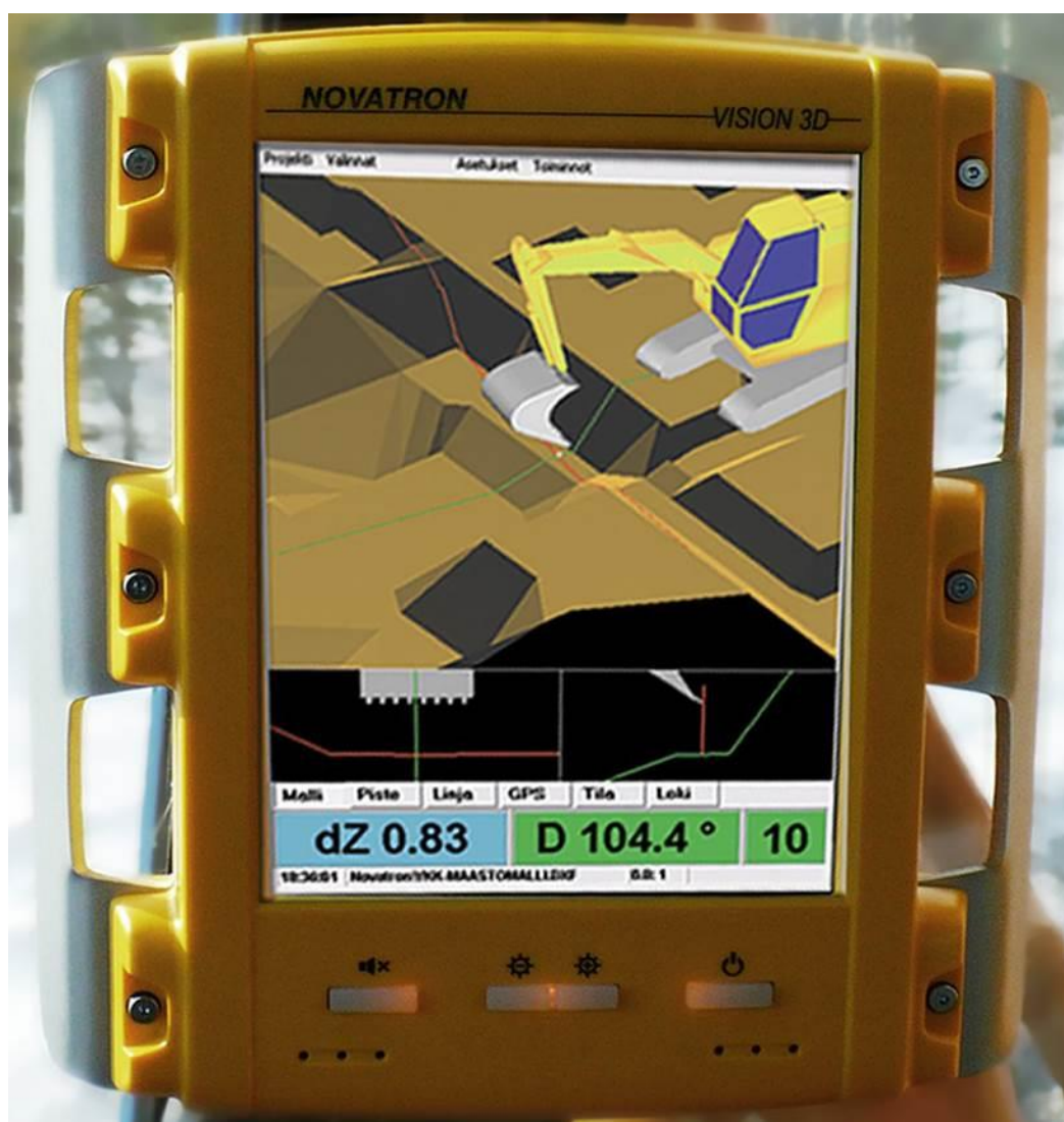
Kuva 6. Näkymä kaivinkoneen näytöstä (Novatron.fi)
