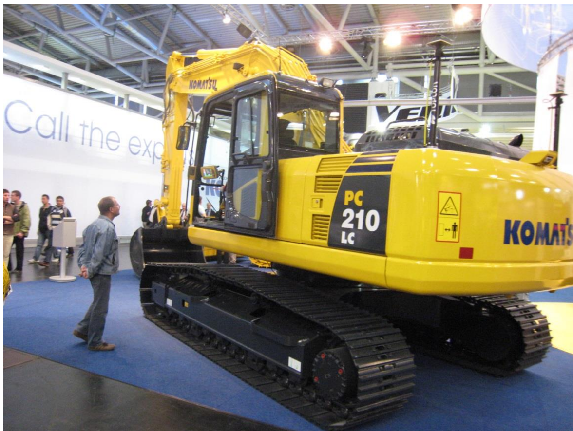
Kuva 12. Bauman messuilla Saksassa esitteillä olleeseen kaivinkoneeseen asennettu Topconin kone-ohjausjärjestelmä. Ulkoisesti järjestelmä on helppo tunnistaa peräpuntin päällä olevista GNSS-antenneista. (Hannuksela 2007)
