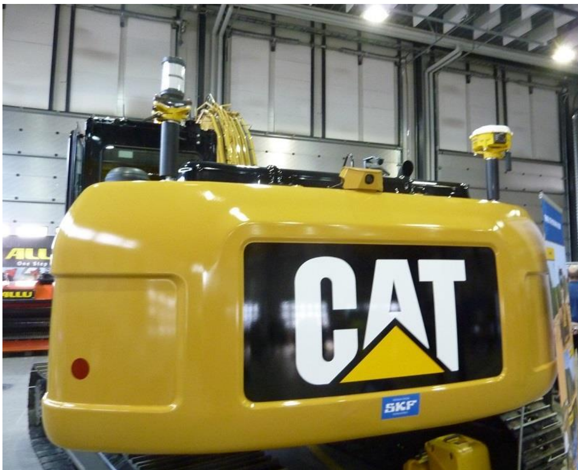
Kuva 14. Kaivinkoneen sijaintitieto voidaan tarvittaessa toteuttaa myös robottitakymetrilla. Tällöin kaivinkoneen peräpuntin päälle asennetaan kuvassa vasemmalla näkyvä aktiiviprisma, jota takymetri seuraa. Kyseisessä järjestelyssä vaikeuksia aiheuttaa kaivinkoneen pyöriminen, sillä hytyn tai puomin tullessa prisman ja mittalaitteen väliin, yhteys katkeaa, eikä kone saa sijaintitietoa. Järjestelmää voidaan hyödyntää työkohteissa, missä yhteys GNSS-satelliitteihin on paikallisten olosuhteiden vuoksi heikko tai täysin estynyt. (Hannuksela 2014)
