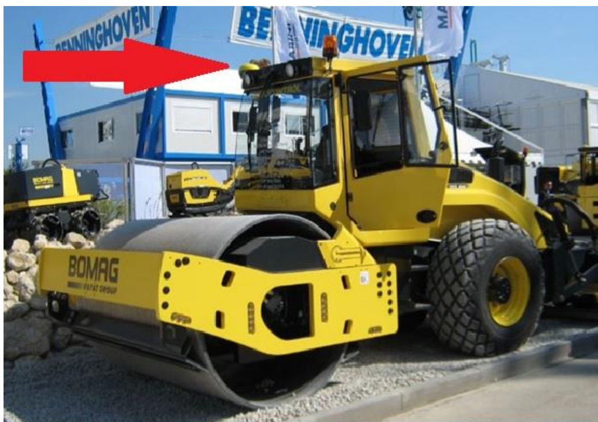
Kuva 21. Koneohjatun jyrän voi tunnistaa hytin ylänurkkaan asennetusta GNSS-antennista (Hannuksela 2007)
