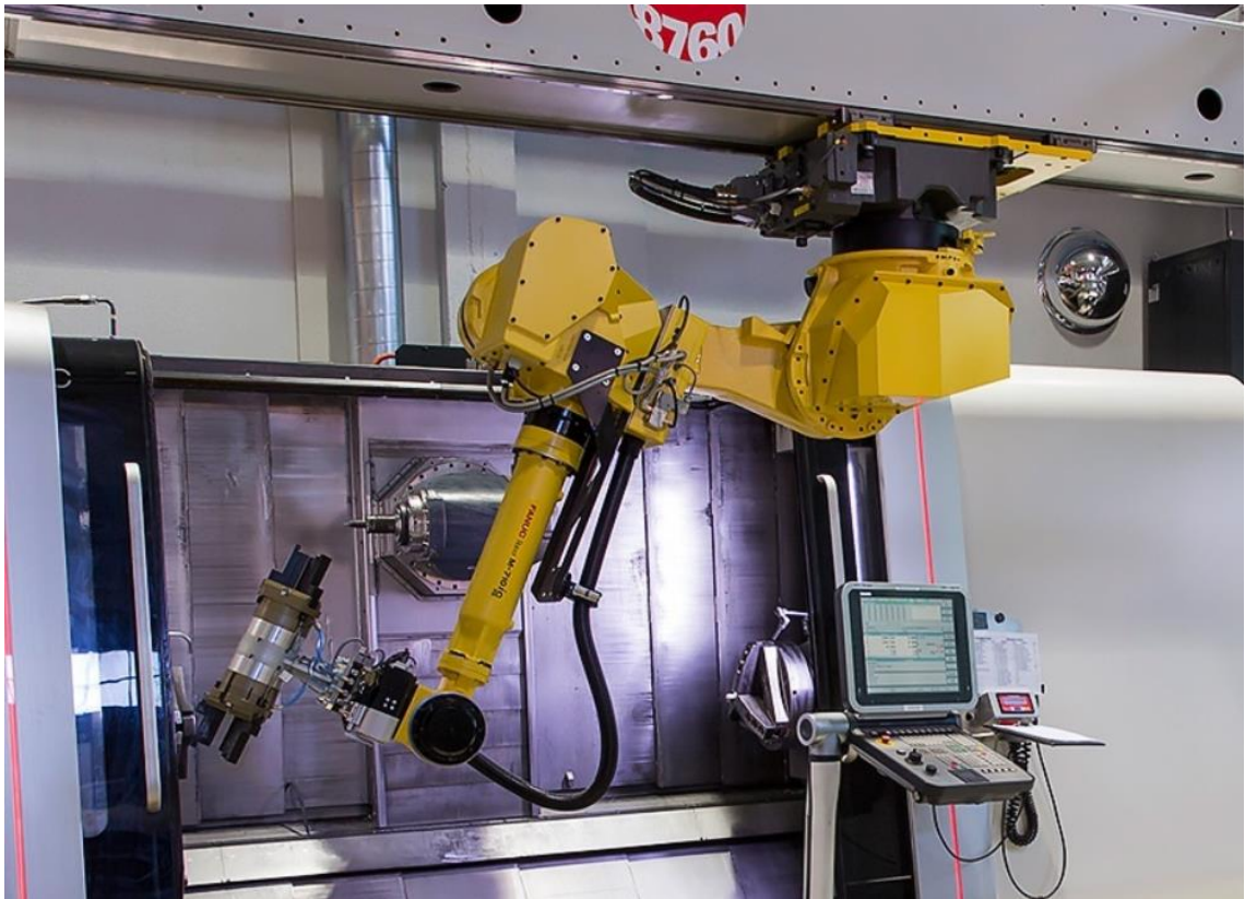
KUVA 3. Koneistuskeskuksen automaattinen panostaja (Fastems: Robot handling 2016)
