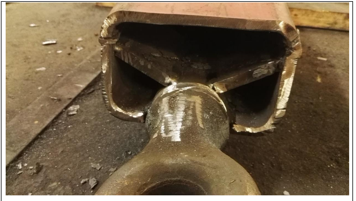
Kuva 41. Vetosilmukan tuenta ja kiinnitys vetoaisaan.
