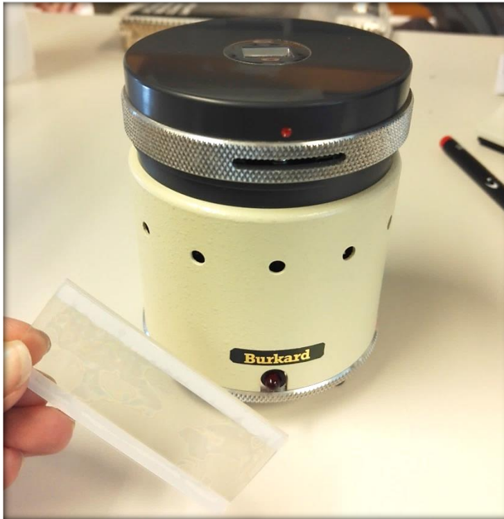
Kuva 12. Mini-Burkard ja geeliteippi. Objekttilasin sijasta mini-Burkardin keräysalustana käytettiin geeliteippiä.
