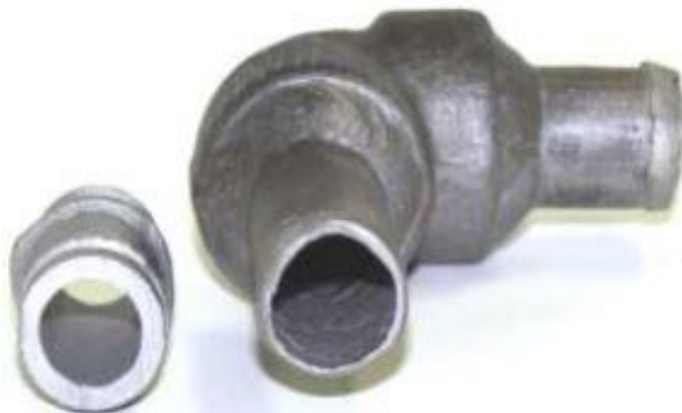
Kuva 8 Alkuperäinen ja kulunut 9Cr-1Mo putki (API RP 571 2011, 4-164.)
