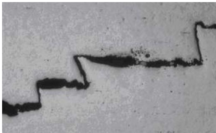
Kuva 14 Mikroskooppikuva HIC-vaurion luonteesta porrasmaiseen, vaiheittaiseen hal- keiluun (API RP 571 2011, 5-67.)
