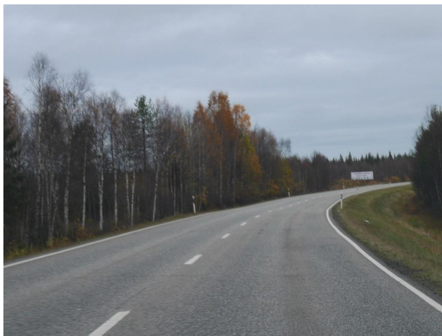
Kuva 7. Yksiajoratainen (1+1) päätie kapealla päällystetyllä pientareella ja keskiviivalla, Vt 4 Rovaniemi (Lepistö 2016).
