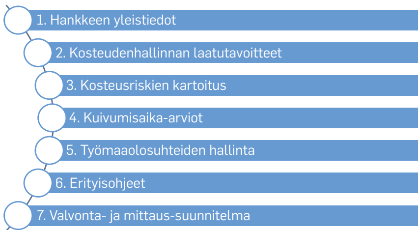
Kuva 15. Rakentamisvaiheen kosteudenhallintasuunnitelman sisältö. (RIL 2011)
