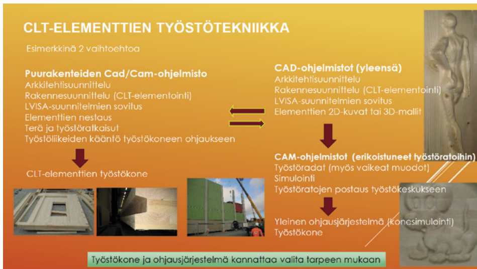
Kuva 6. CLT-elementtien työstötekniikka (Yliniemi M. 2015)
