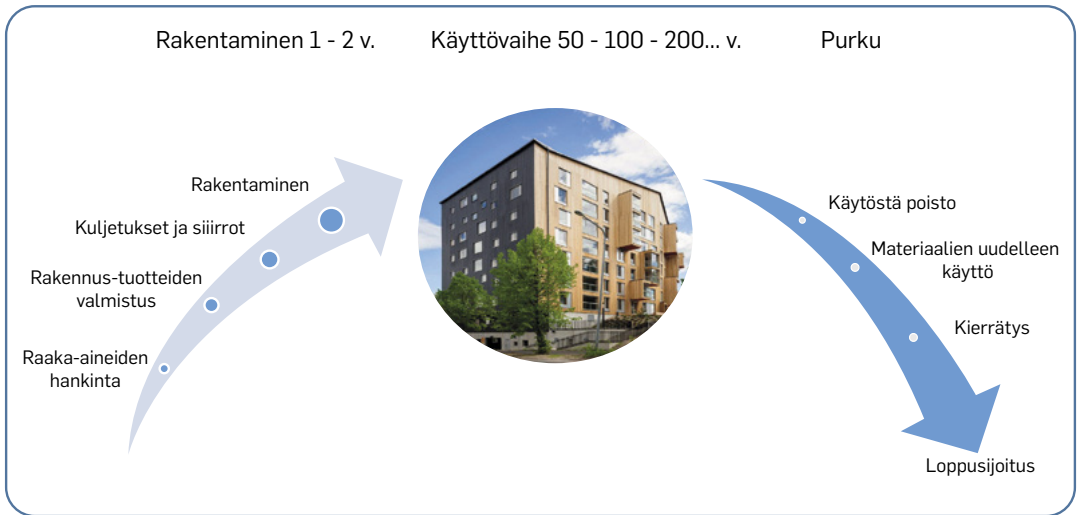
Kuva 3. Rakennuksen elinkaari (Puuinfo 2015) (Puuinfo 2017)
