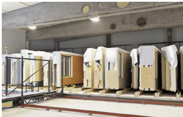
Kuva 3. Valmiita puisia suurelementtejä (Lapwall 2016)
