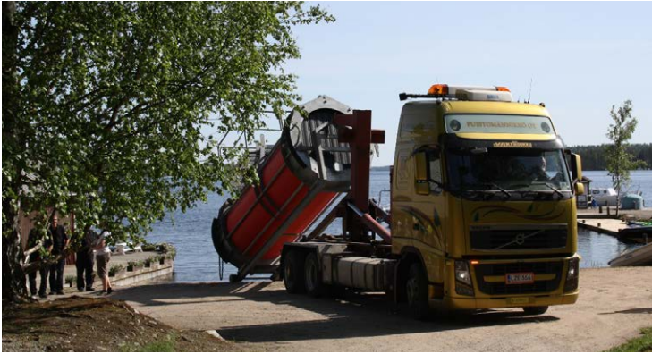
KUVA 7. Keräyssäiliö tuodaan rantaan koukkulava- kuorma-autolla (kuva Justiina Halonen 2015).
