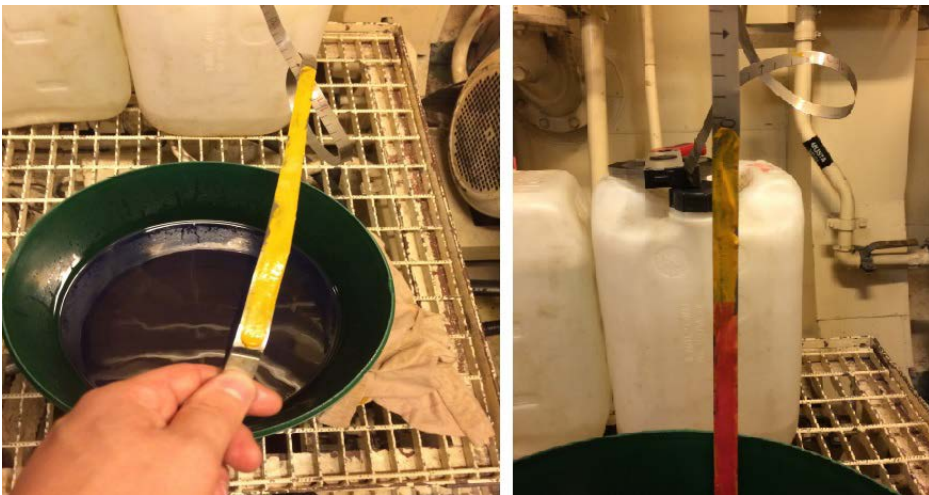
KUVA 2. Keltainen vesipasta, jonka kevytpolttoöljy värjää punaiseksi, siveltynä peilauspilkkiin (kuva Henri Heino 2016).
