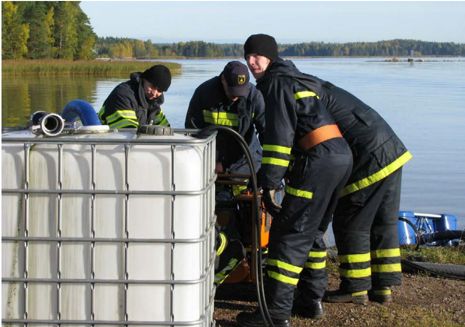
KUVA 5. Nestemäisen öljyjätteen välivarastointiin soveltuva IBC-kevytsuurpakkaus skimmerin keräyssäiliönä (kuva Justiina Halonen 2009).
