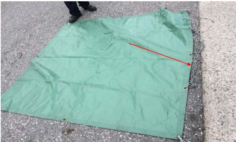
KUVA 4. Puolustusvoimien käyttämä vuotomatto pressukankaasta. Nuoli näyttää ketjun, joka pitää maton irti aluksen kyljestä sekä vetää maton veden alle (kuva Henri Heino 2016).
