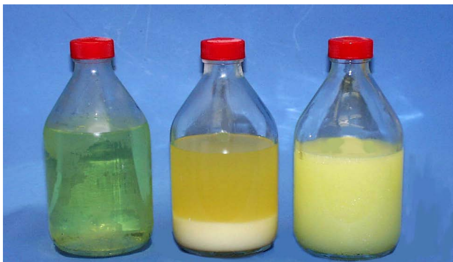
KUVA 6. Laivadieselin DMA- ja DMB-laatujen parafiinien kiteytyminen samepisteessä (kuva Tuukka Hartikka 2015).
