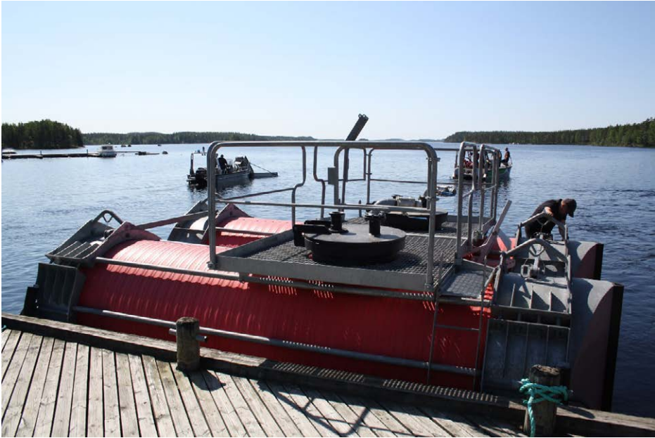
KUVA 6. Hinattava keräyssäiliö yhdistettynä tankkipariksi teräksisellä yhdysrakenteella (kuva Justiina Halonen 2015).
