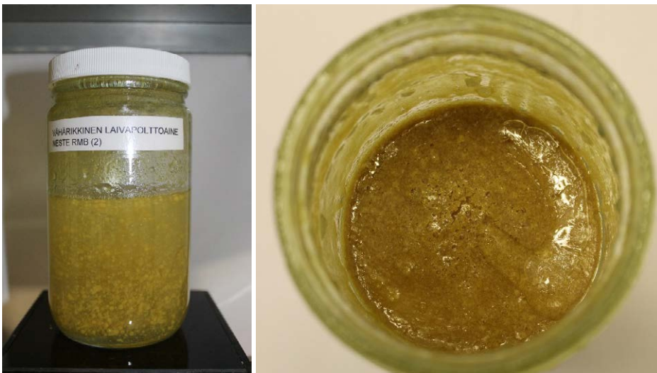
KUVA 9. Vähärikkinen laivapolttoaine Neste RMB jähmettyi kylmässä (+5 °C:ssa) sekoitettaessa, ja öljykalvo jäätty pakkasessa (kuvat Mariia Zhaurova).
