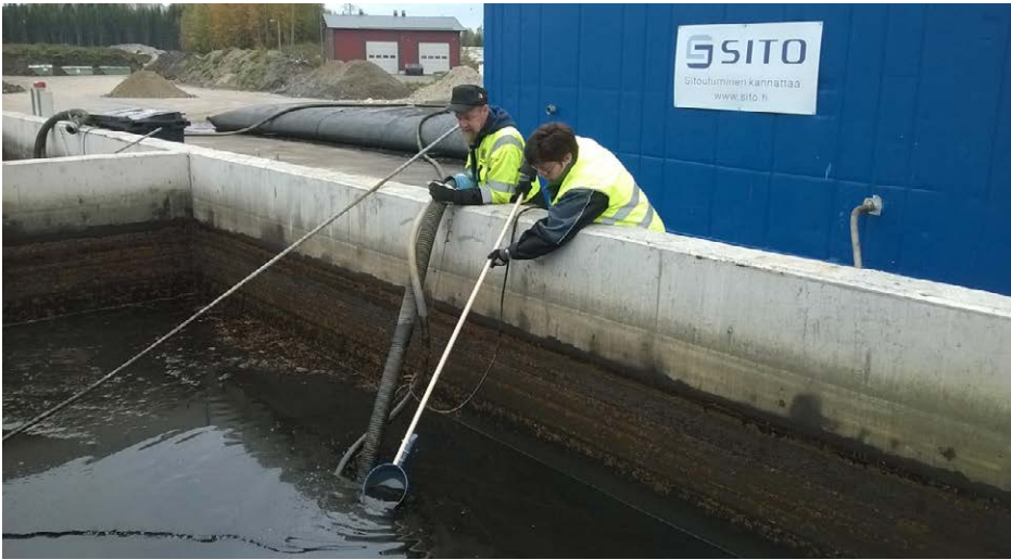
KUVA 3. Näytteenotto öljynerotuslietealtaasta (kuva Vuokko Malk 2016)
