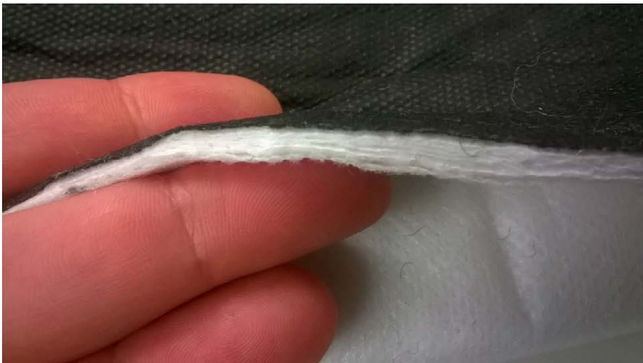
KUVA 3. Keräystyömaan suojaukseen käytettävää rannansuojamattoa. Tämä mattotyyppi asennetaan musta puoli ylöspäin (kuva Justiina Halonen 2016).
