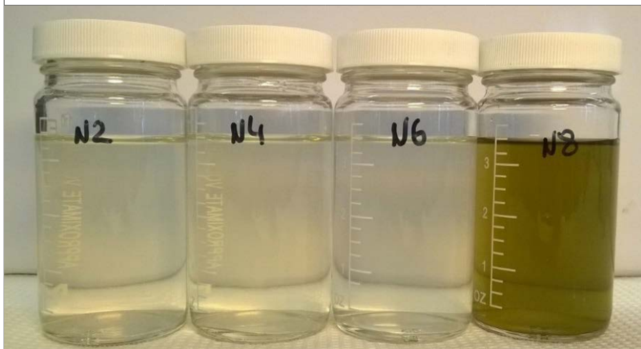
KUVA 16. Vesinäytteet eri öljytuotteilla saastutetun a) hiekkamaan ja b) orgaanisen maan läpi kulkeutuneesta vedestä (kuvat Mariia Zhaurova). (Kuvat 2. rinnakkaisesta toistosta.)
