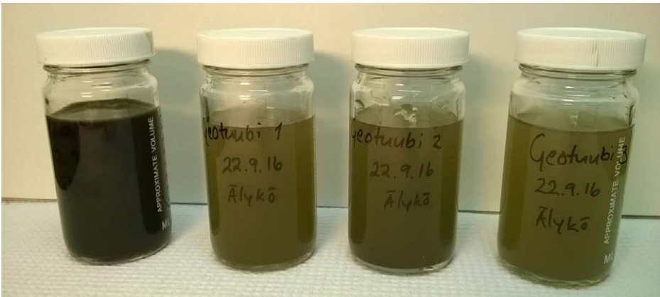
KUVA 5. Öljynerotuslietealtaasta (ensimmäinen pullo vasemmalta) otettu näyte sekä geotuubin läpi suotautuneesta vedestä kerätyt kolme rinnakkaista näytettä (kuva Vuokko Malk 2016).
