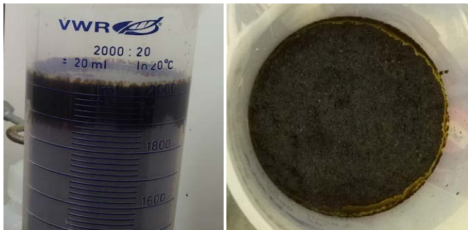
KUVA 15. Pyrolyysiöljyn pidentyminen pintamaahan (kuvat Mariia Zhaurova).
