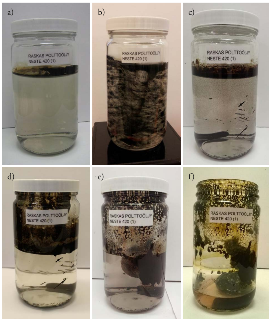
KUVA 8. Raskaan polttoöljyn Neste 420:n käyttäytyminen makeassa vedessä: a) 1 vrk: 5 minuuttia öljyn lisäämisen jälkeen, b) 1 vrk: magneettisekoituksessa, c) 2 vrk: 5 minuuttia 24 tunnin magneettisekoituksen jälkeen, d) 3 vrk: 5 minuuttia 24 tunnin magneettisekoituksen jälkeen +5 °C:ssa, e) 14 vrk: 5 minuuttia 12 vuorokauden ravistelijassa sekoituksen jälkeen, f) 21 vrk: haihtunut kansi auki vetokaapissa viikon (kuvat Mariia Zhaurova).
