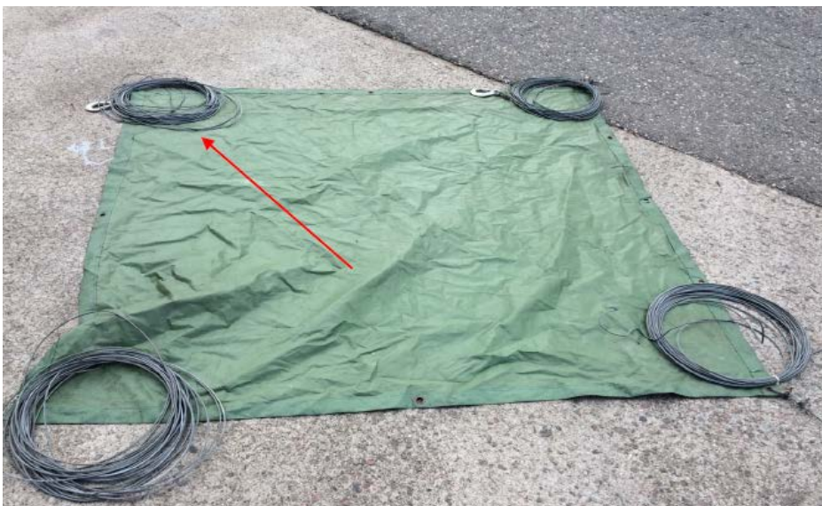
KUVA 5. Puolustusvoimien käyttämä vuotomatto, jossa on vaijerit reunoissa maton paikalleen asettamisen helpottamiseksi (kuva Henri Heino 2016).
