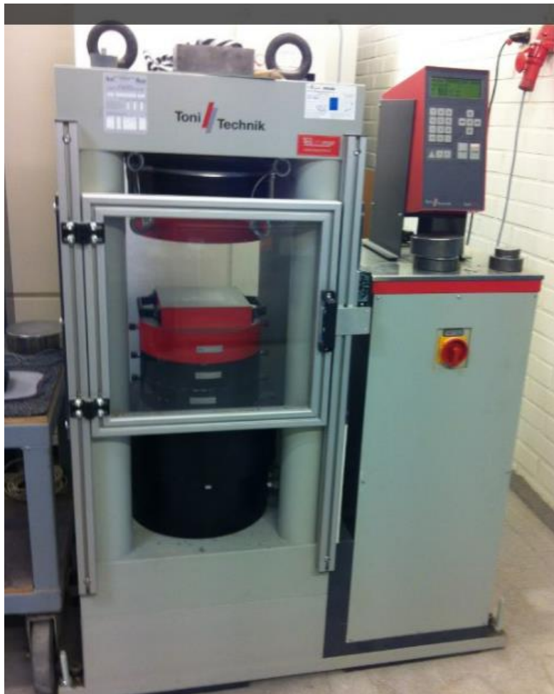
Kuva 13. Toni Technikin puristuslaite
