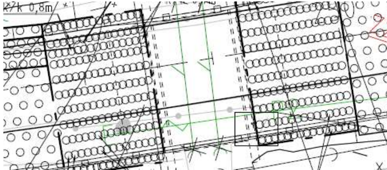
Kuva 13. YIT:n työkuvassa näkyy lamelli pilarointia, jolla tuetaan tulevaa silta rakennetta.
