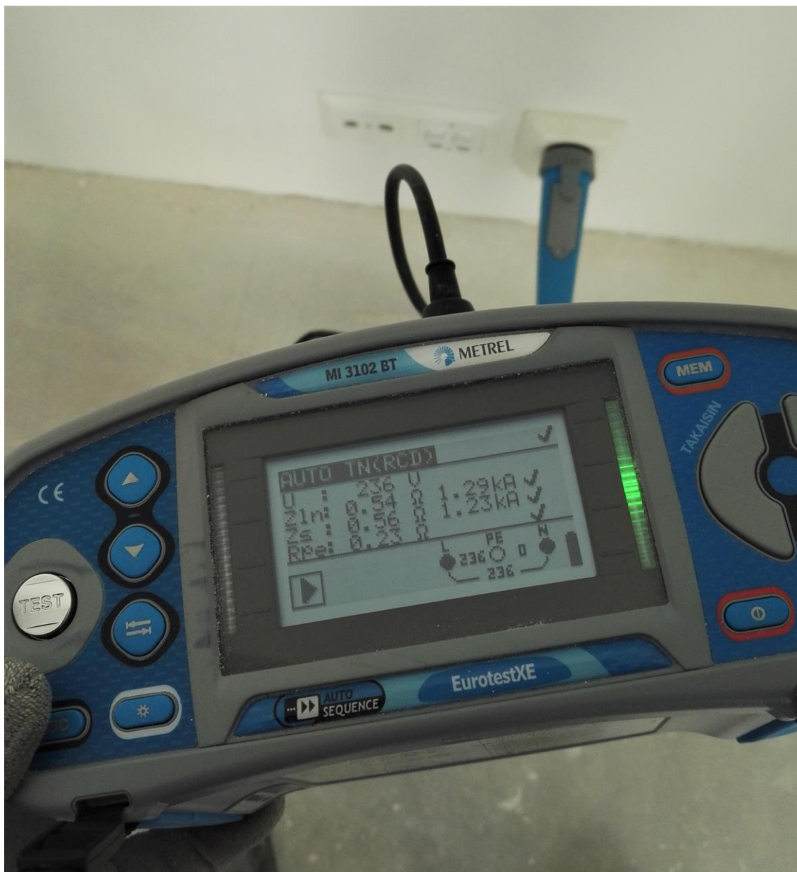
Kuva 15. Kuva automittauksesta. Mittari ilmoittaa vihreällä valolla, mikäli mittaus on hyväksytty.
