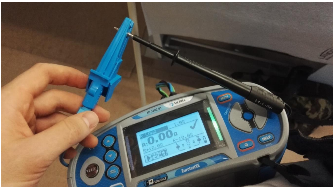
Kuva 7. Kuva, jossa varmistetaan, että mittajohdit on kalibroitu.
