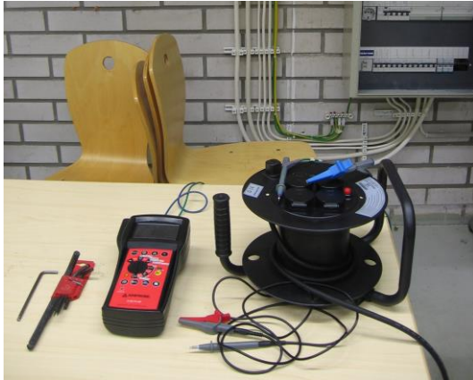
Kuva 20. Mittatesteri ja apujohto (kela) jatkuvuuden mittaamiseksi.
