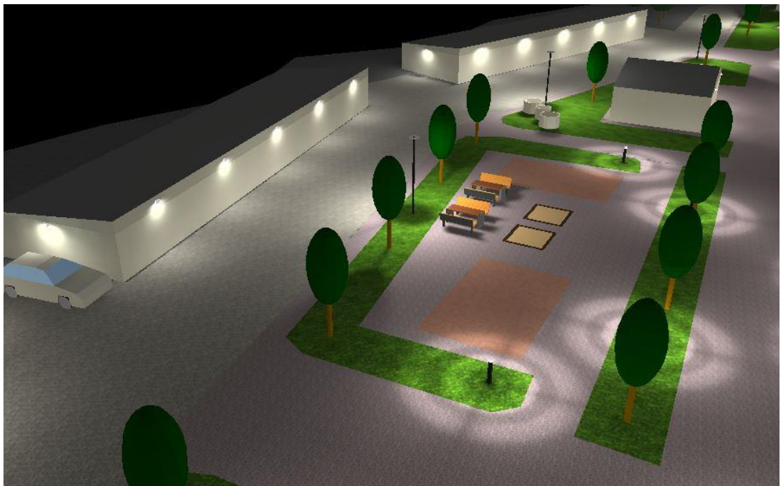
KUVA 6. DIALuxilla luotu näkymä kohteesta. Valaistuksen mitoituksessa painopiste on toiminnallisten alueiden ja kulkuväylien valaisussa.
