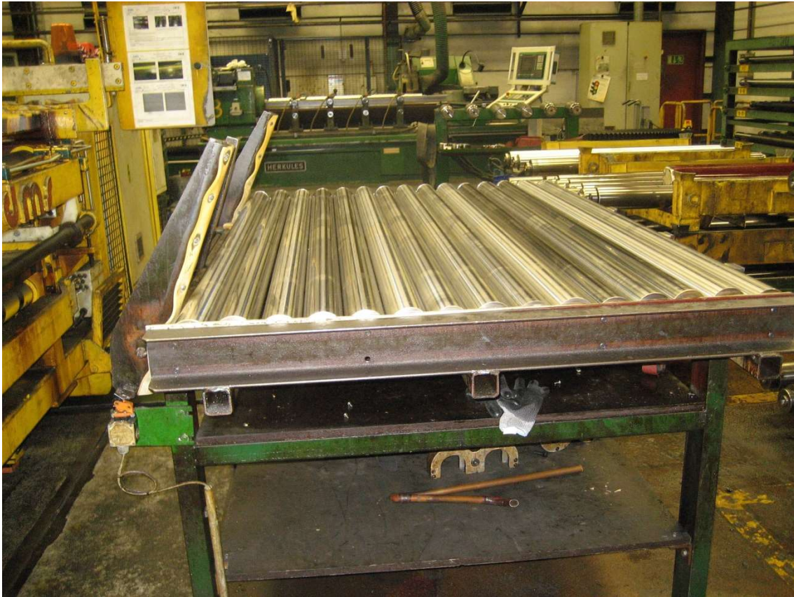
KUVA 4. SZ1-valssaimen hiottuja työvalsseja valssihiomossa
