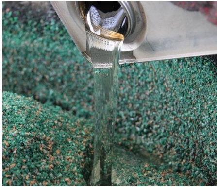
Kuva 7. Sideainetta kaadetaan kumirouheen sekaan (Made-in-China n.d.).
