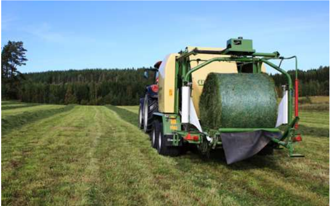
Kuva 1. Paalaus kone työssä pellolla. Paalaus koneen kyydissä paalaus verkolla kääritty heinäpaali. (Piippo 2016.)
