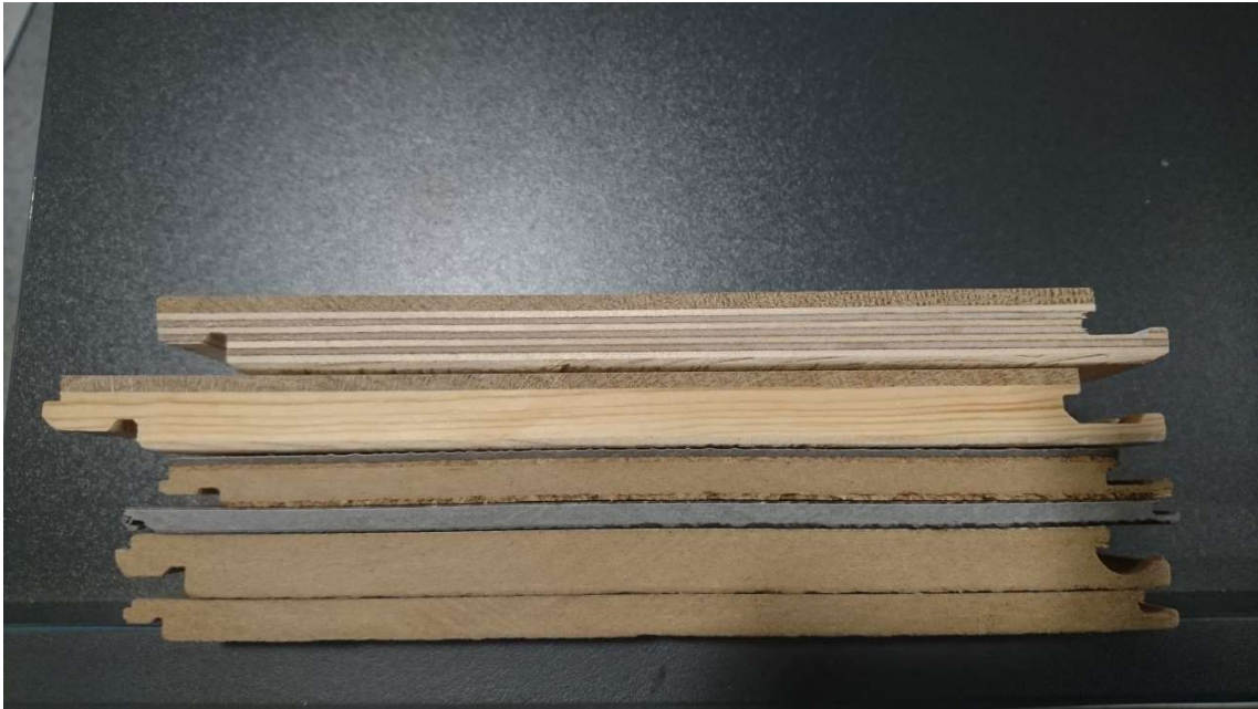
(Kuva1. Lattiamateriaaleja. Koivuvanerirunkoinen lautaparketti (ylhällä), havu- vanerirunkoinen lautaparketti, vinyylilikorkki, vinyylilankku, 12mm:n laminaatti, 8mm:n laminaatti)
