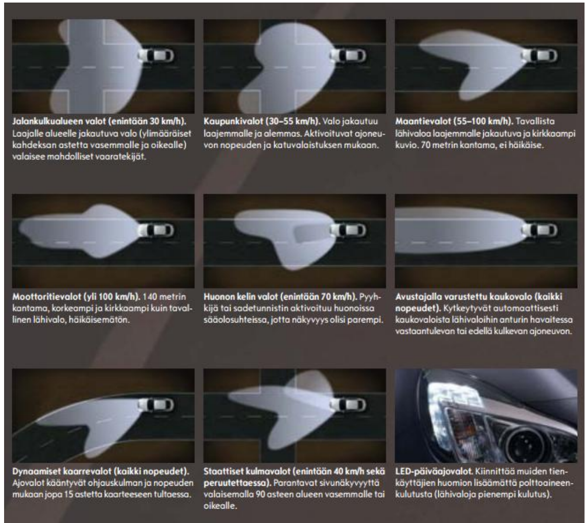
KUVA 15. Opel Insignia AFL-järjestelmän valojakaumat (Opel Insignia – esite 2011)
