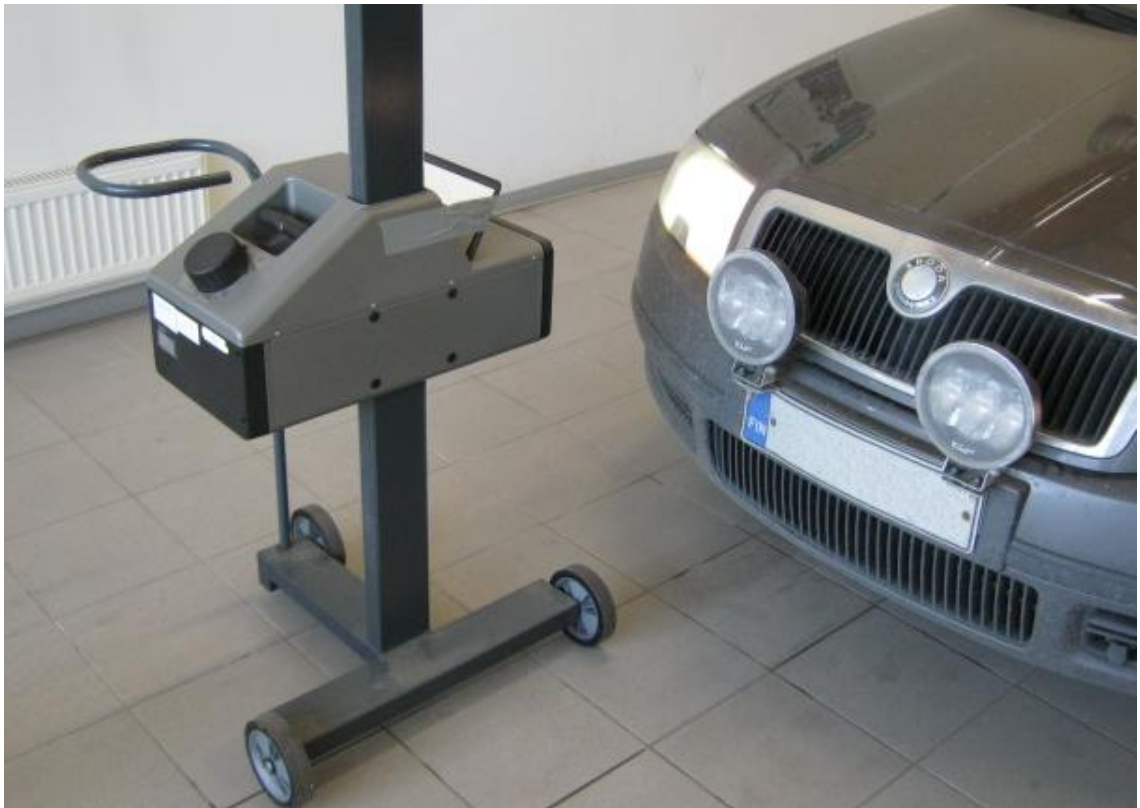
KUVA 17. Skoda Superb lähi- ja etusumuvalon korkeus- ja sivuttaissuuntauksen testaus valojensuuntauslaitteella (Kuva: Aarne Sihvola 2016)
