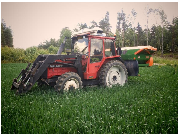
Bild 2: Traktor och gödselspridare med Yara N-sensor TM på taket
