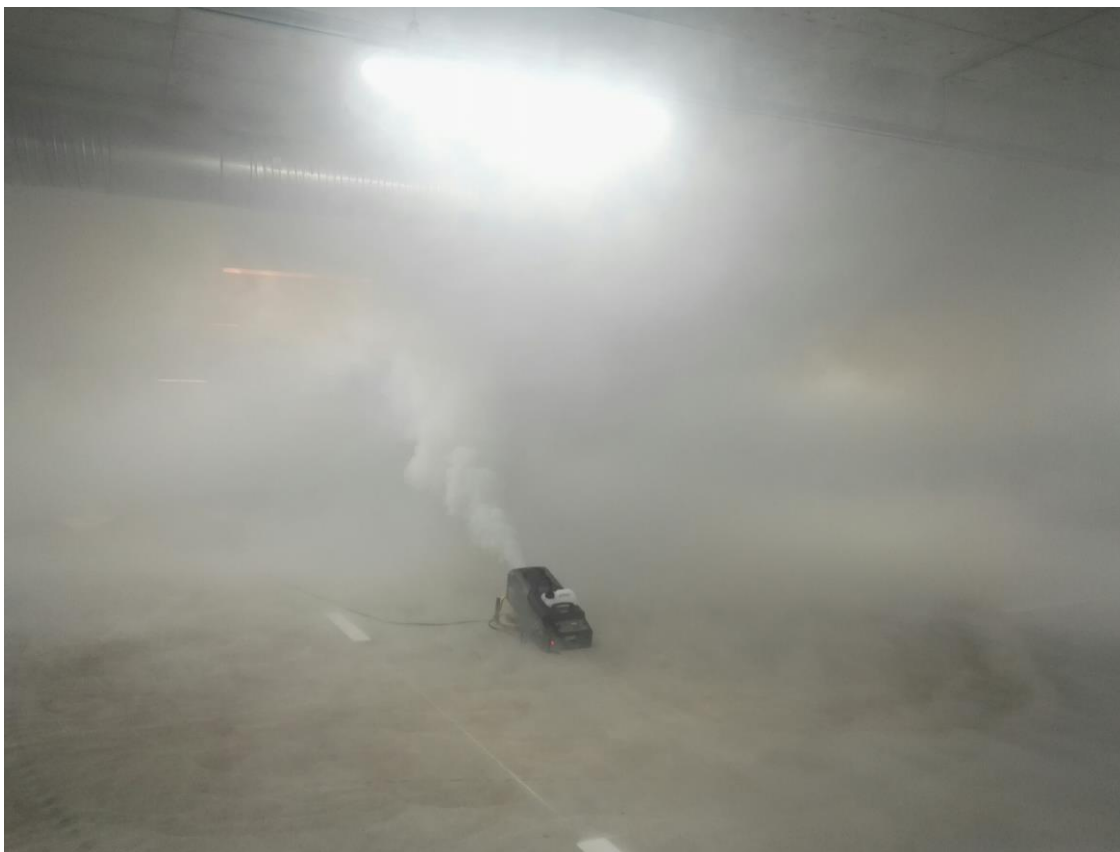
Kuva 5. Parkkihallin kylmäsavukoe Järvenpäässä.
