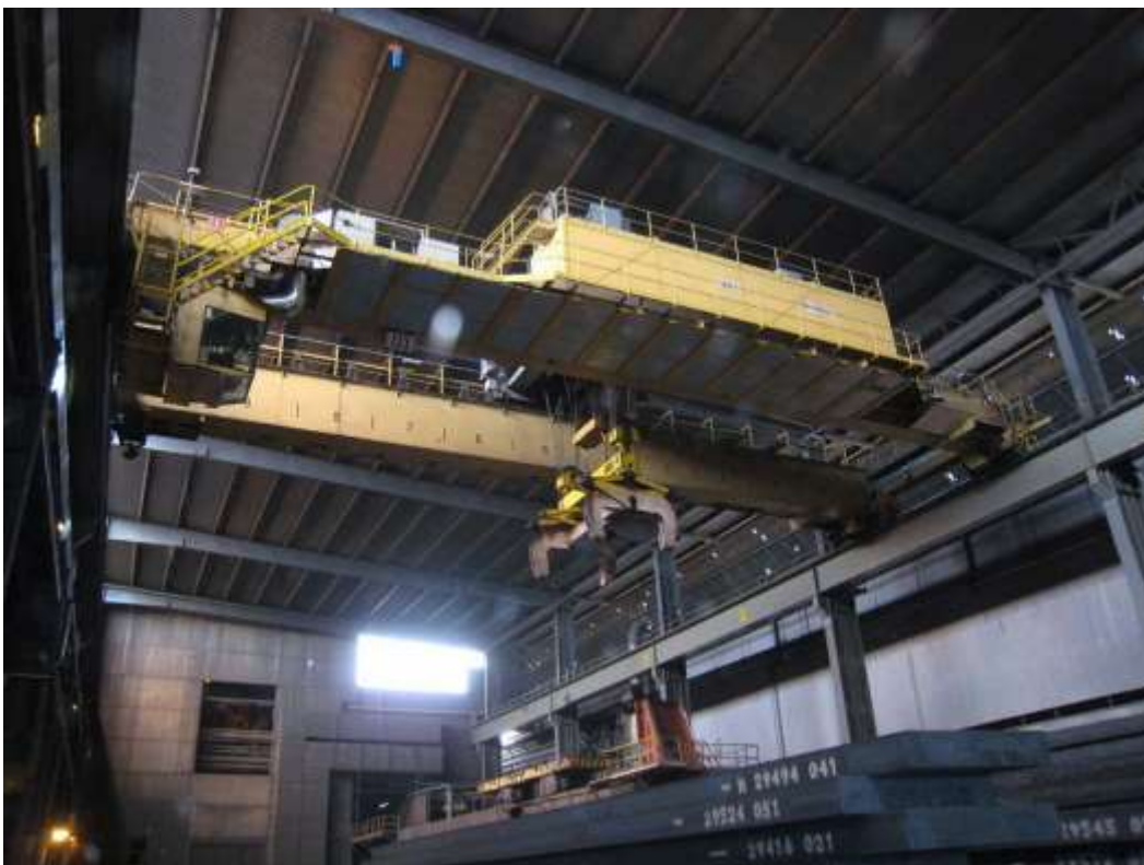
KUVA 2. Raahen tehtaan terässulattolla toimiva siltanosturi. Nosturiratapalkit tuettu pilarikonsoleihin. (Arola 2011, 9.)
