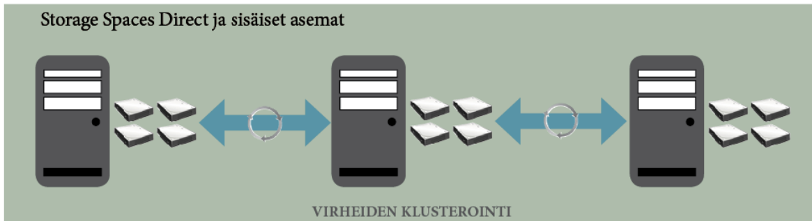
KUVIO 7. Storage Space Direct hyödyntää SMB3:ssa kaikkia sisäisiä solmuja, kuten SMB suora ja SMB Multichannel. Tämä mahdollistaa alhaisen latenssin ja suuren suoritustehon varastoinnille.
