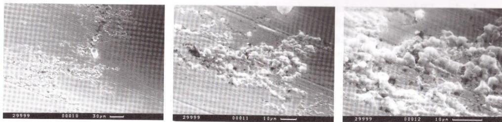
Kuvio 7. Aktiivisen lisäaineen aiheuttama korrosio (Teollisuusvoitelu, 36)
