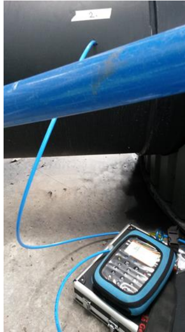
KUVA 5. Rikkivedyn ja ammoniakin mittaus suoraan linjastosta
