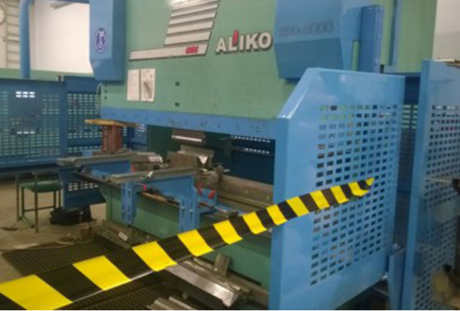
Kuva 3. Alikon särmärin käyttöä suojausterästen särmättävyyden testauksessa.
