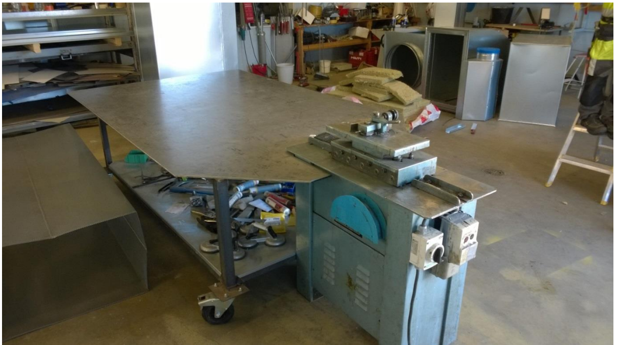
Kuva 2. Lockformer ja työpöytä Merilapin Ilmastointipalvelu Oy:n tiloissa.
