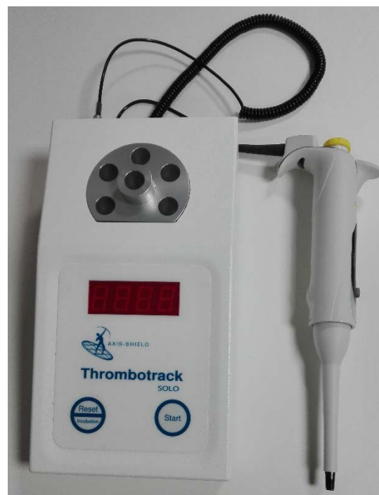
KUVA 1. Thrombotrack™ Solo -hyytymislaite ja automaattipipetti (Koivunen 2016-10-04).
