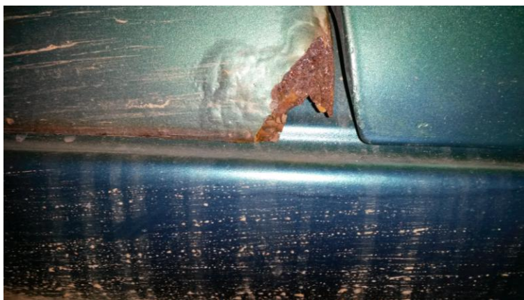
KUVA 7. Terävä reuna kuljettajan oven nurkassa. Tämä ei vielä vaikuta kolariturvallisuuteen, mutta voi aiheuttaa vaaraa kevyelle liikenteelle sekä käytettäessä ovea. Lähde: Pekka Purosola 2015.
