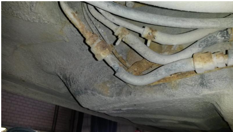
KUVA 13. Syöpyneitä jarru- ja polttoaineputkia. Jarruputkista tulee tarkkaan arvioida vuotovaara. Myös polttoaineputket kannattaa katsoa tarkkaan, sillä niiden vuotaessa on kyseessä ympäristöhaitta tai palovaara. Tässä kunnossa jarruputkistosta voi jo antaa hylkäyksen. Lähde: Pekka Purosola 2015.
