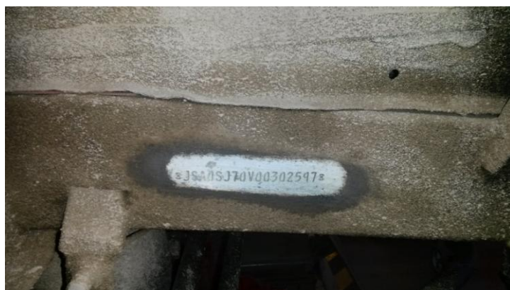
KUVA 15. Suzuki Samurain runkoon lyöty valmistenumero. Ruostevahinko tällä kohtaa on mahdollinen. Kuva: Pekka Purosola 2015.
