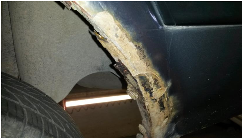
KUVA 11. Voimakkaasti pintaruosteessa oleva lokasuojan reuna. Tämä ei vielä aiheuta katsastajan merkintöjä, mutta asiakkaalle on syytä ehdottaa ruosteen poistamista. Kuva: Pekka Purosola 2015.
