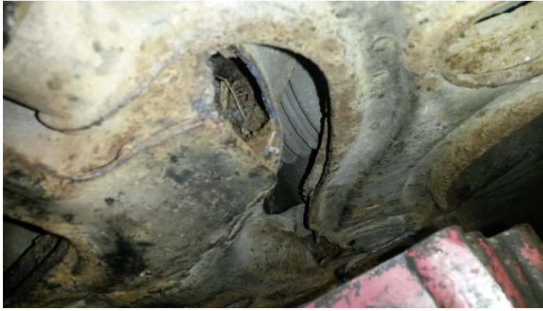
Kuva 10. Edellisen kuvan auton alaturkivarren kiinnityspisteen ruosteaurio vasemmalla. Tämä johti katsastuksen hylkäämiseen. Laajempi, helaa lähemmäksi kasvanut oleva vahinko olisi johtanut ajokieltoon. Kuva: Pekka Purosola 2016.
