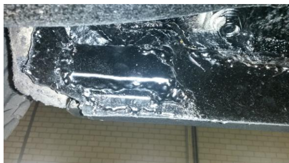
Kuva 16. Tasaisella hitsaussaumalla korjattu sisähelmakotelon ruostevaurio, joka on myös selvästi saatettu alkuperäiseen muotoonsa ja päällystetty suojamassalla. Kuva: Pekka Purosola 2015.
