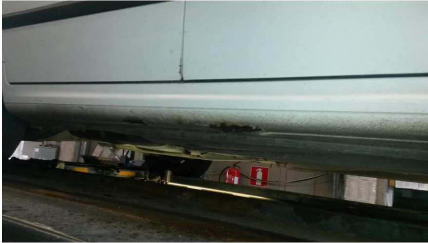
KUVA 4. Kaksi ruostevauriota henkilöauton helmakotelossa. Kuvassa näkyy koko helmakotelo vaurion laajuuden esittämiseksi. Reikien välinen alue on myös vaurioitunutta, joten sekin on poistettava ja korjattava hitsaamalla. Lähde: Pekka Purosola 2015.
