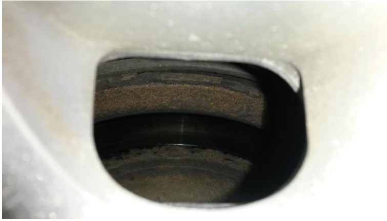
KUVA 12. Jarrulevyjen ruostuneisuus tarkastetaan silmämääräisesti vanteen tuuletusreikien kautta. Myös sisäpinta auton alta on tarkastettava mikäli mahdollista. Kuvassa reilu kolmannes jarrulevystä ruostunut. Kuva: Pekka Purosola 2015.
