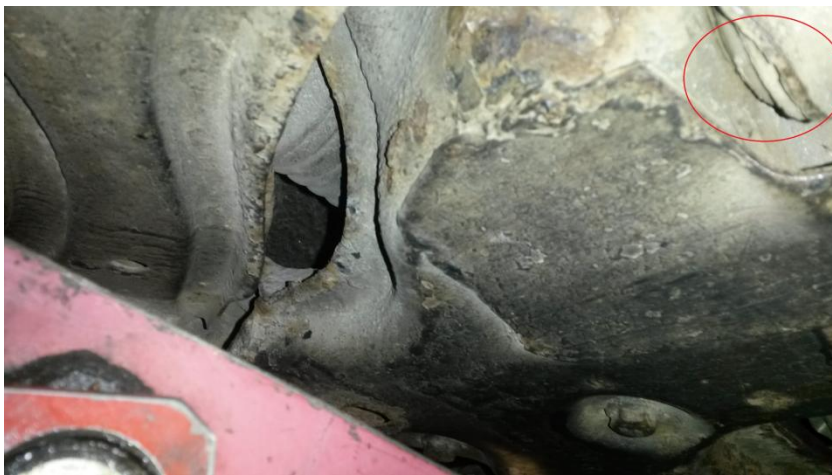
Kuva 9. Volkswagen Golf –henkilöauton oikeanpuoleisen etualatukivarren kiinnityspiste (ympyröity). Tämä on todettu katsastuksessa ehjäksi. Lähde: Pekka Purosola 2016.
