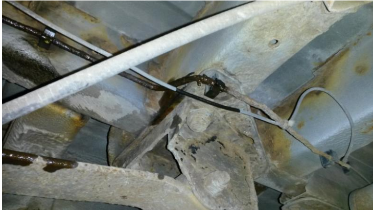
KUVA 14. Puhkiruostunut jarruputki vuotaa (Peugeot Boxer). Kun vuoto on jo alkanut, tulee tutkia millainen vuoto on ja millaisia lisäongelmia vuodosta on koitunut tai on koitumassa. Kuvassa runsas, 3-vikaan johtava vuoto. Kuva: Pekka Purosola 2015.
