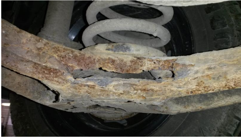
KUVA 8. Puhkiruostunut takatukivarsi (Daihatsu Charade). Murtumavaara on ehdottomasti otettava huomioon. Tämä on vielä arvosteltavissa 2-vikana, mutta jo hieman laaja-alaisemmasta tulisi ajokielto. Lähde: Pekka Purosola 2015.
