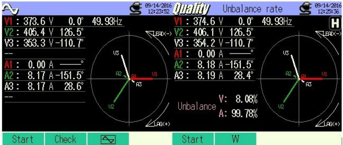
Kuvio 13. Kaksivaiheisen moottorin mittaukset.
