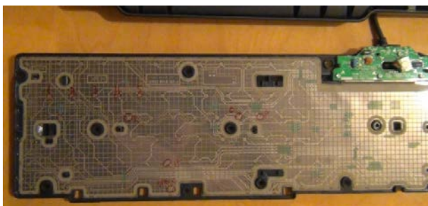
Kuva 20. Näppäimistömatriisiin on merkitty kaikki tarvittavat näppäimet.
