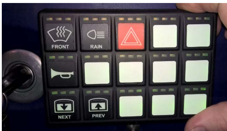
Kuva 24. Kiinnitystä vaille valmis näppäinpaneeli toimilaitetarroilla.
