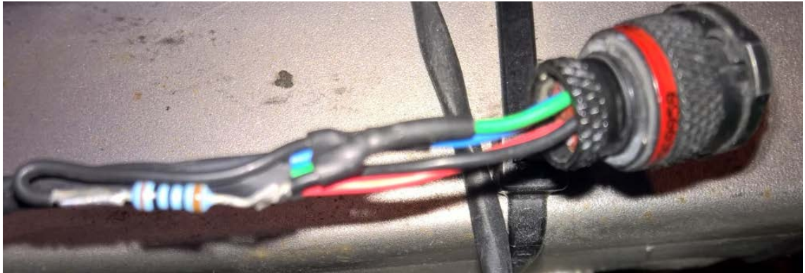
Kuva 16. Beacon-kierroskaskurin lisälaitteen liittimessä oleva poistettava vastus.
