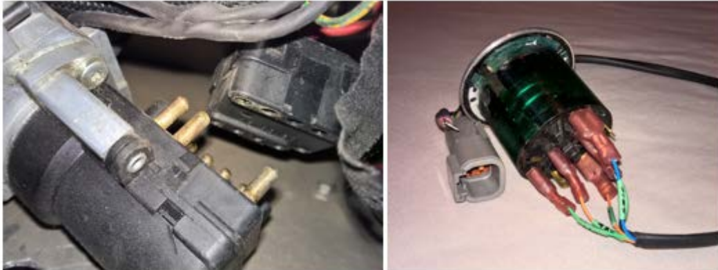
Kuva 5. Vasemmalla virtalukon pohja vanhalla liitinrungolla ja oikealla valokatkaisija uusin liittimin.
