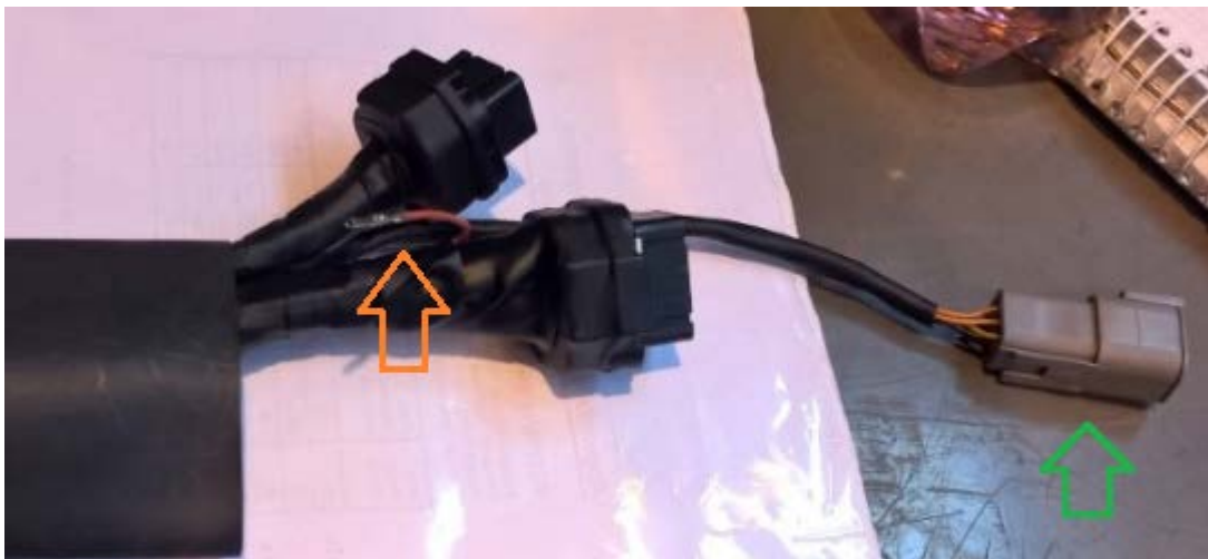
Kuva 14. Bypass-venttiilin valmius oranssi nuoli ja pyöräantureiden liitin vihreä nuoli.
