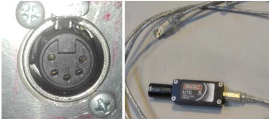
Kuva 20. Vasemmalla ohjelmointipistoke kojelaudan alla ja UTC-adaptteri oikealla.
