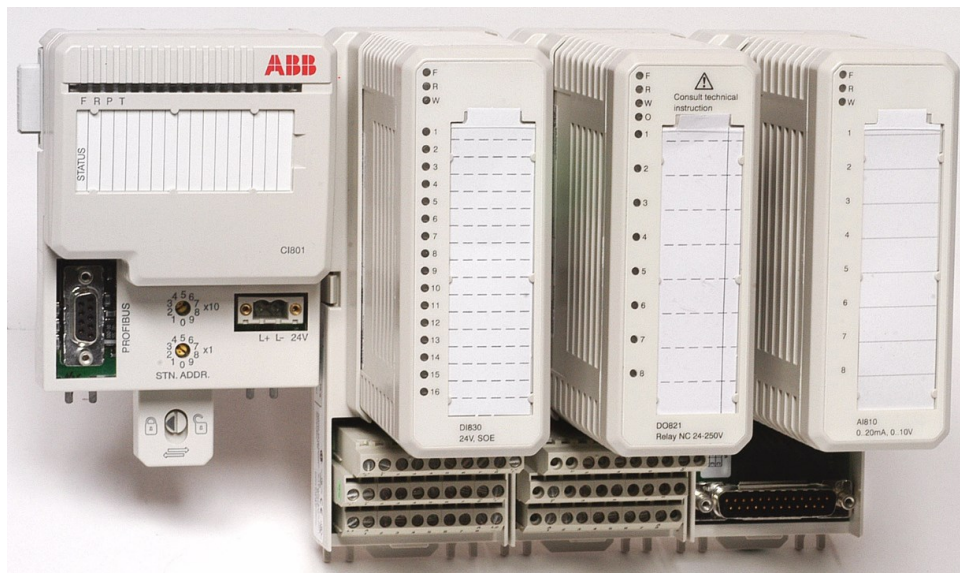
Kuva 13. S800 I/O kytkettynä FCI-väyläyksikköön CI801 ja I/O-moduulit asennettuna moduulipohjiin (ABB 2013, a, 23).
