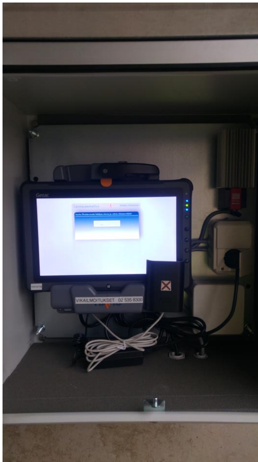
Kuva 4. Seinään kiinnitetty veropäätte lämmitetyssä kaapissa
