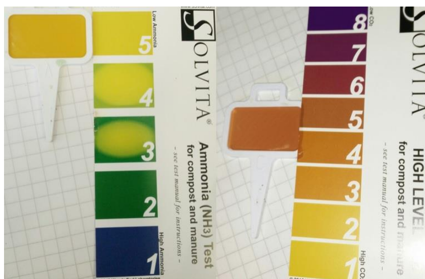
KUVA 8. NH 3 - ja CO 2 -liuskojen värin vertaaminen värikarttaan (Minna Vartiainen).
