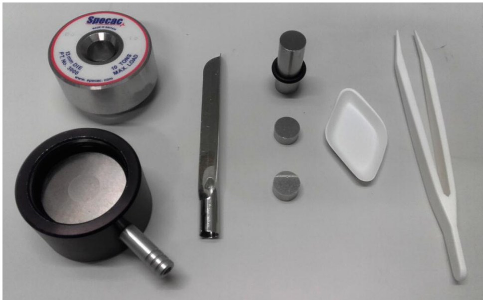
Kuva 9. Pellettien puristamiseen tarvittavia välineitä. Kuvassa näkyvät muotin osat, joita tarvitaan pellettipuristimeen, sekä pinsetit ja paperinen laiva näytteen käsittelyä ja punnitusta varten.
