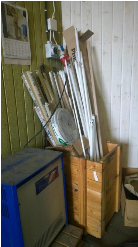
Kuva 3. Loisteputket on varastoitu kunnan varikolla laatikkoon nurkassa. Ne ovat vaarassa kaatua ja rikkoutua. © Mira-Susanna Vilamaa
