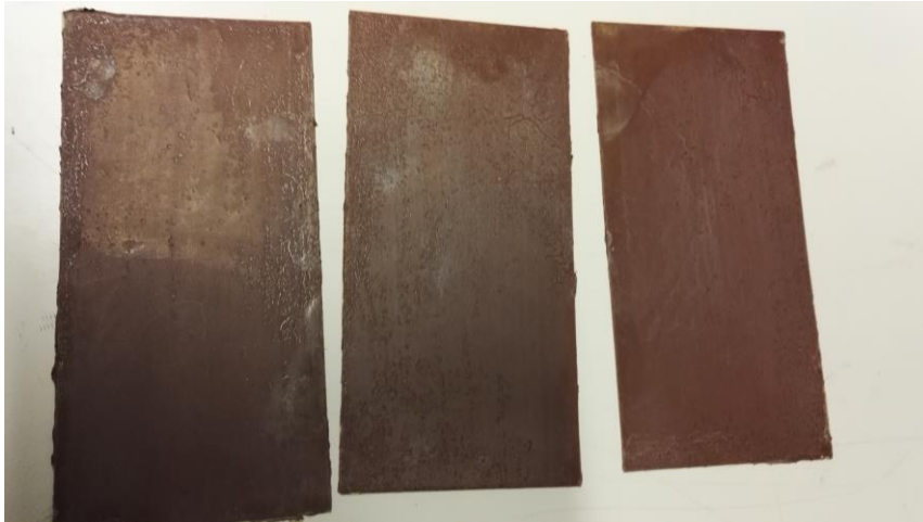
Kuva 3. Ksenon-testissä olleet liuotinhenteiset palat
