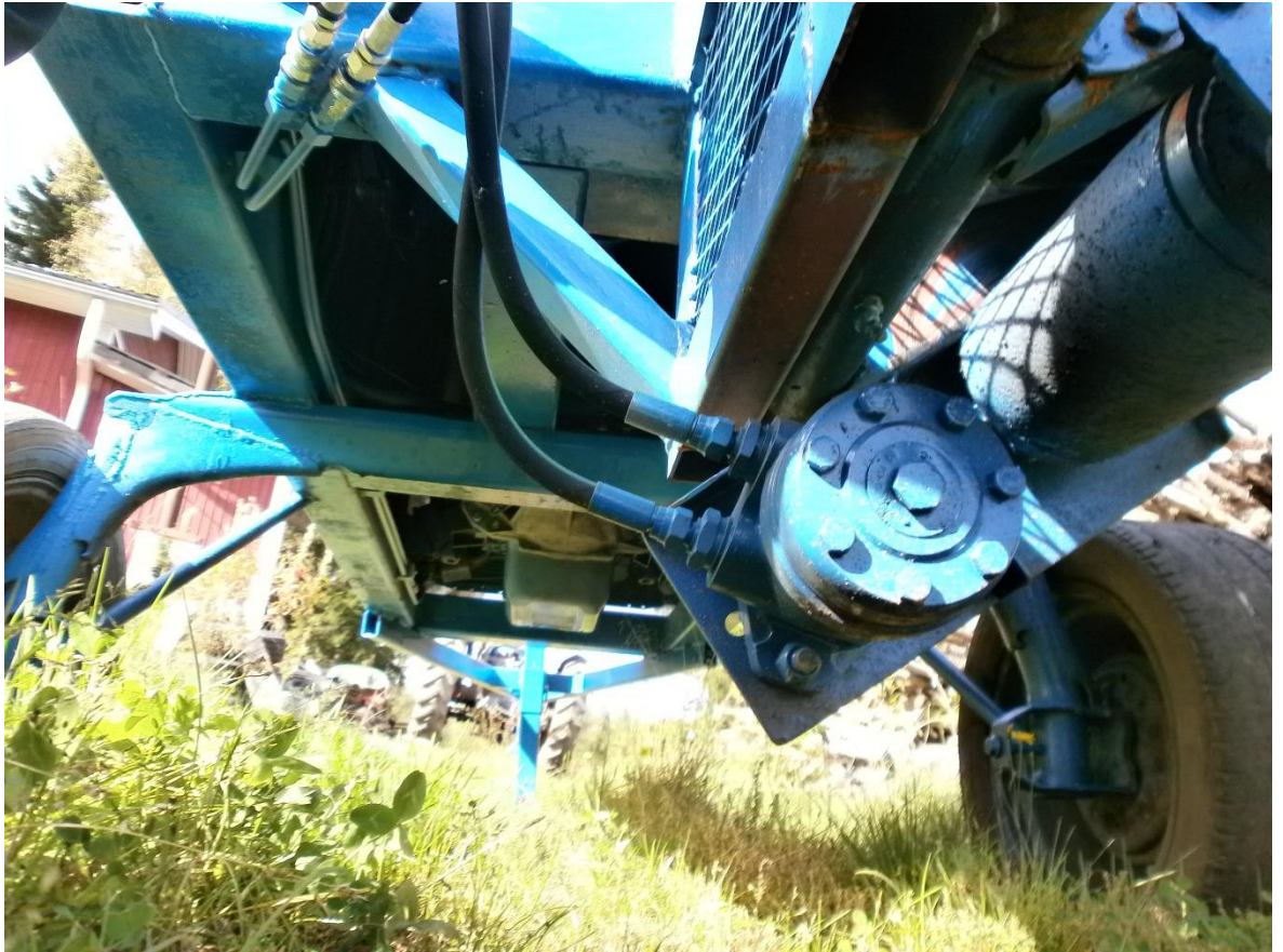
KUVIO 11. Hydrauliiikka putket, hydraulimoottori ja pikaliittimet
