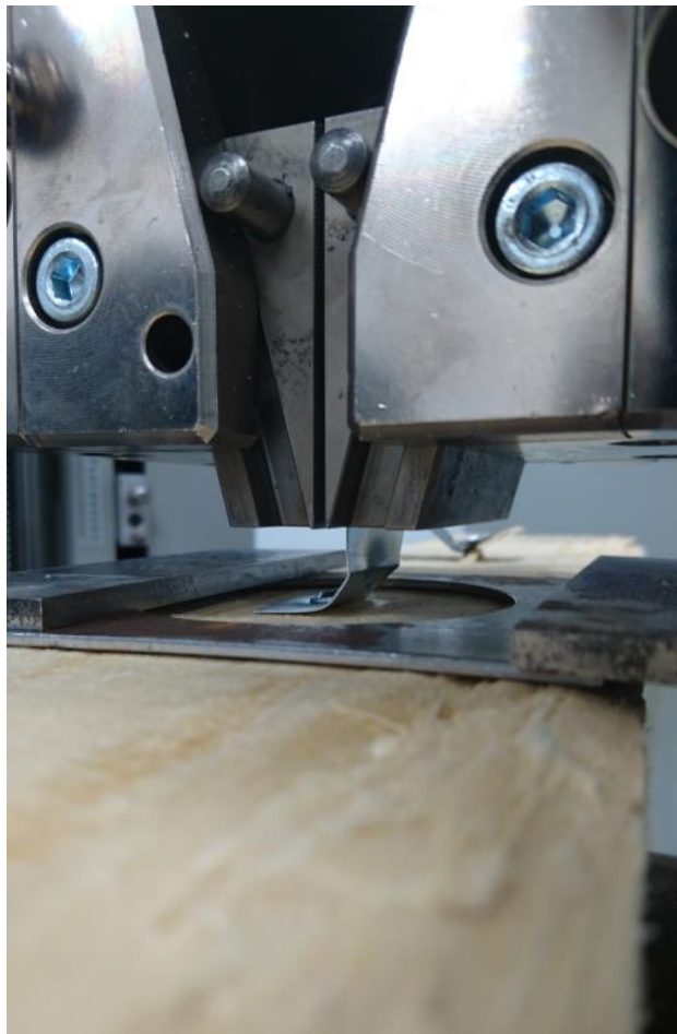
Kuva 14. Ulosvetolujuustesti. (Kuva: Juho Rönkkö)
