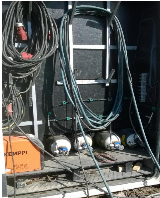
Kuva 1. Paineilmapulloyksistä koostuva varailmapankki.
