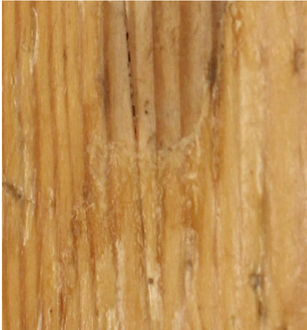
Kuva 15. Asetonilla kiinnityksestä aiheutuneet rypyt lakkapintaan
