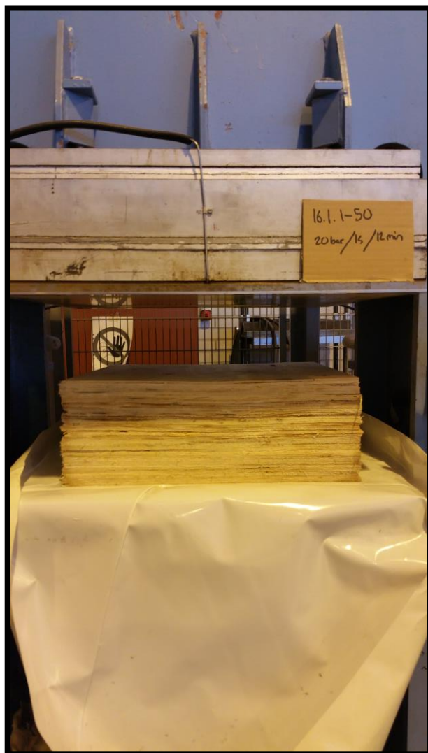
KUVA 10. Puristimeen laitettiin muovikaukalo, joka ohjasi veden asiaan.
