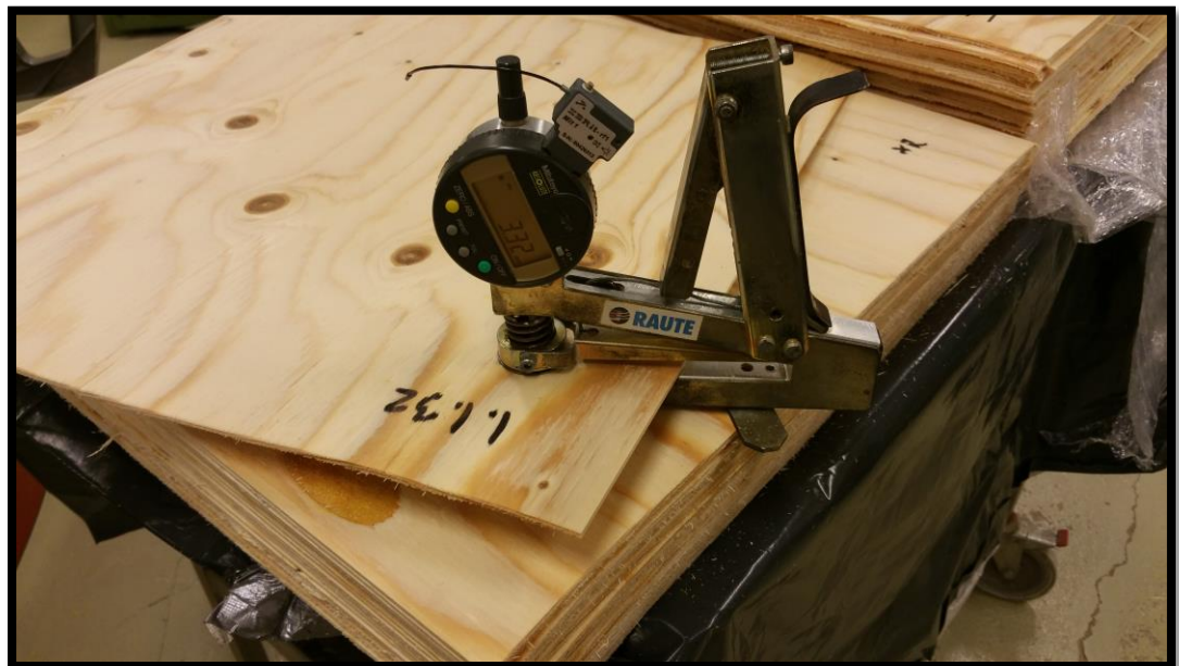
KUVA 7. Viilujen paksuuden mittausta.
