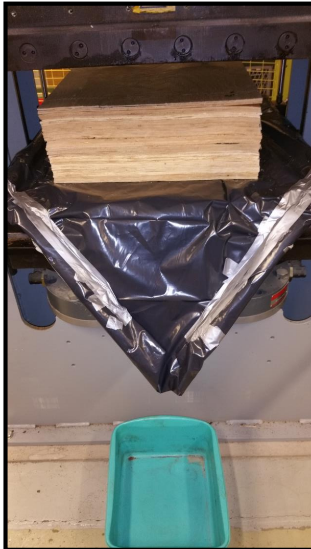
KUVA 6. Muovinen kaukalo ohjaa poistuvan veden astiaan.
