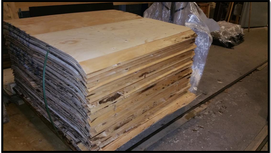
KUVA 3. 1200 x 1200 millimetrin viilut ennen sahausta.
