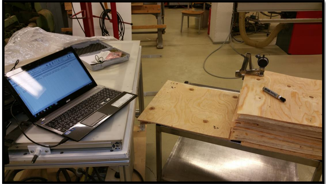
KUVA 5. Viiluarkkien numerointia ja paksuusmittausta.
