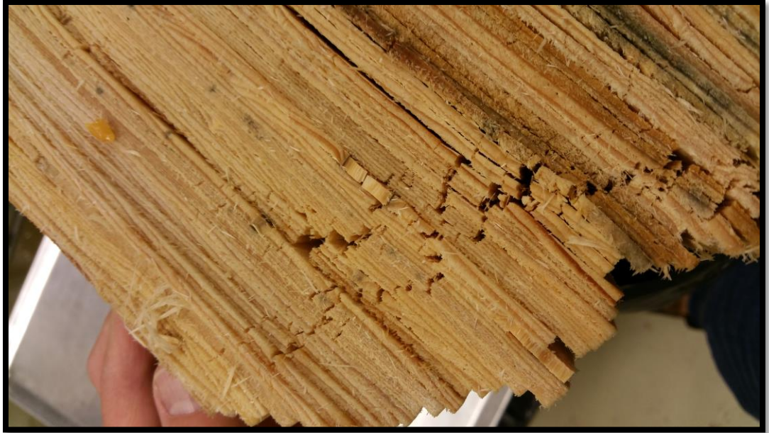
KUVA 11. Viilut hajosivat 40 baarilla puristettaessa.
