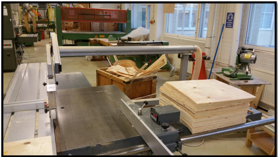
KUVA 4. Pyörösahalla sahattuja 500 x 500 millimetrin viiluja.
