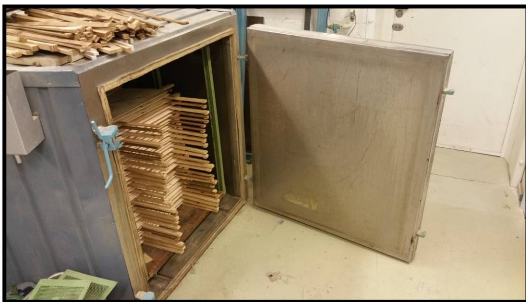
KUVA 9. Viilut Lahden ammattikorkeakoulun laboratorion kuivausuunissa.
