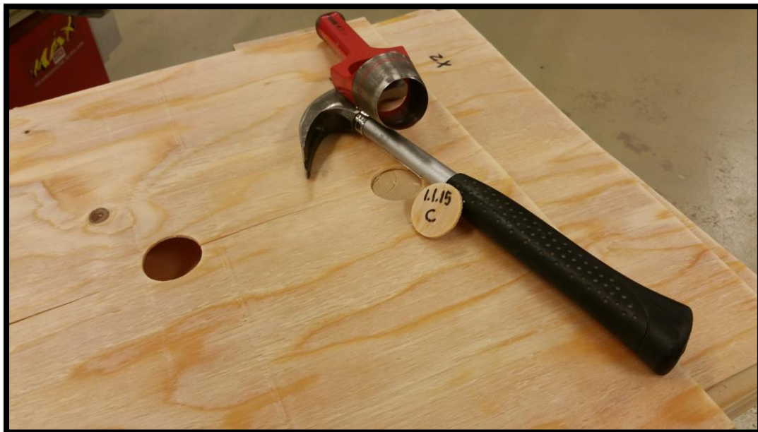
KUVA 8. Viiluista lyötiin meistillä koepalat irti.
